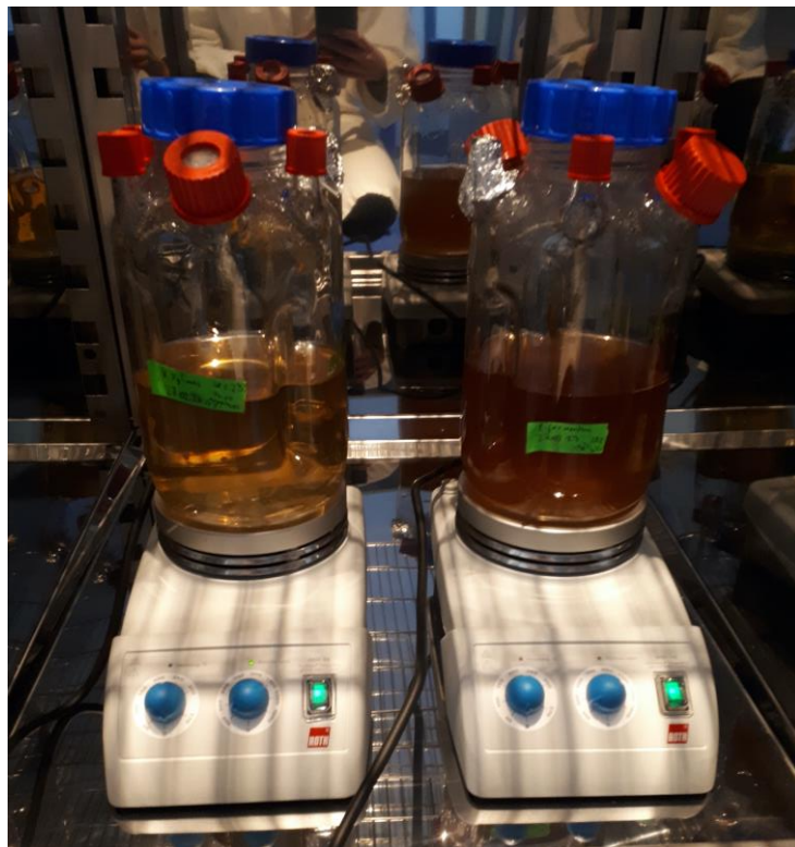
Abbildung 7: Rührkessel mit Magnetrührstäbchen auf Magnetrührplatten im Inkubator
