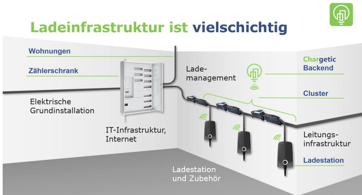
**Abbildung 2.2-2: Technische Bestandteile einer skalierbaren Ladeinfrastruktur**
