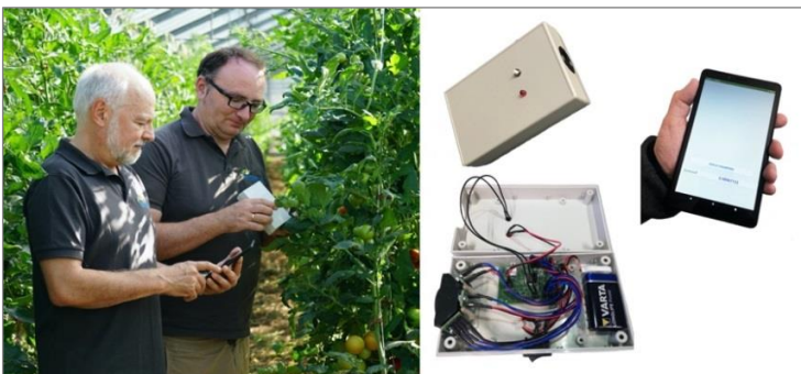
Abb. 2: Labormuster im Einsatz bei einem Pilotkunden und technischer Aufbau mit App.
