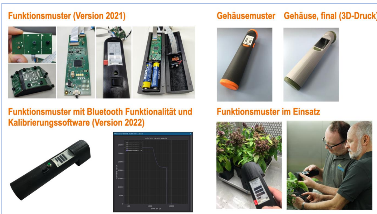
Abb. 6: Technische Entwicklungsstufen des Funktionsmusters und des Gehäuses.
