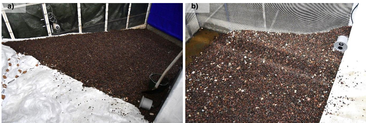
Abb. 3.19 Anrampungen vom Rinnenboden zur Modelloberfläche im (a) Ober- und (b) Unterwasser. (Aufnahmen: Eikenberg)
