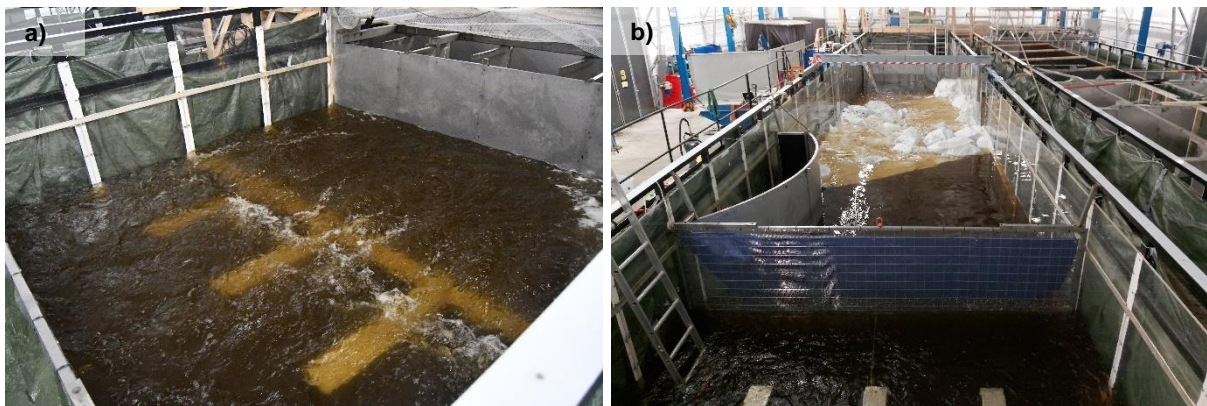
Abb. 3.18 a) Stoßschwelle im Einlaufbereich der Rinne; b) Gitterwand als obere Begrenzung der Modell- bzw. Versuchsstrecke. (Aufnahmen: Eikenberg)
