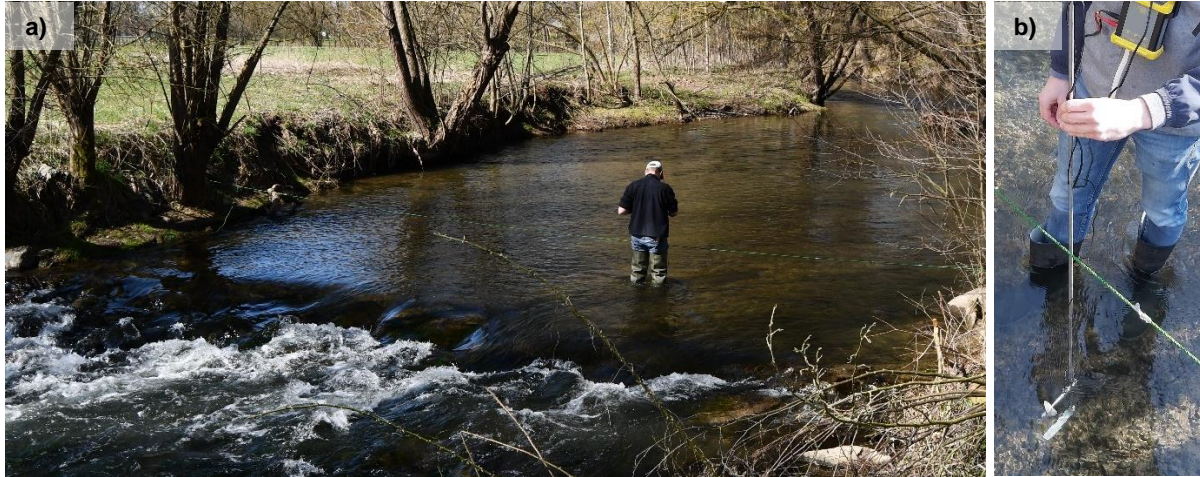
Abb. 3.11 Geschwindigkeitsmessungen zur Erstellung einer h-Q-Beziehung für die Gleite. a) Messquerschnitt im Oberwasser der Gleite; b) hydrometrischer Flügel. (Aufnahmen: Eikenberg)
