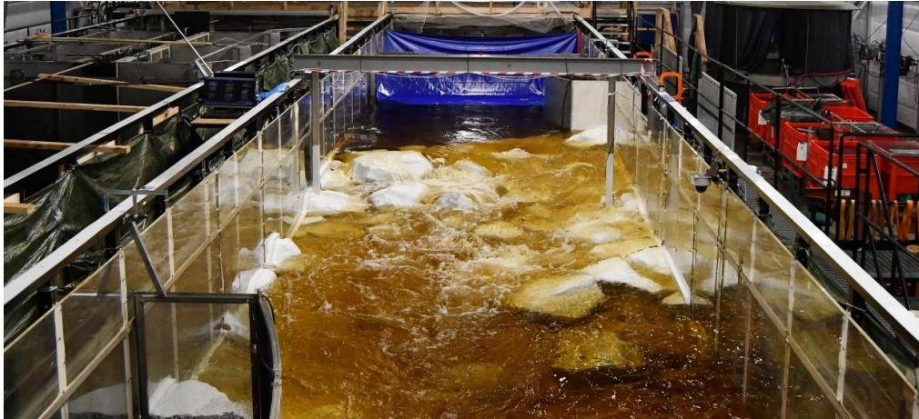
Abb. 3.22 Das fertiggestellte Modell der Sohlengleite im Testbetrieb (Aufnahme: Eikenberg)
