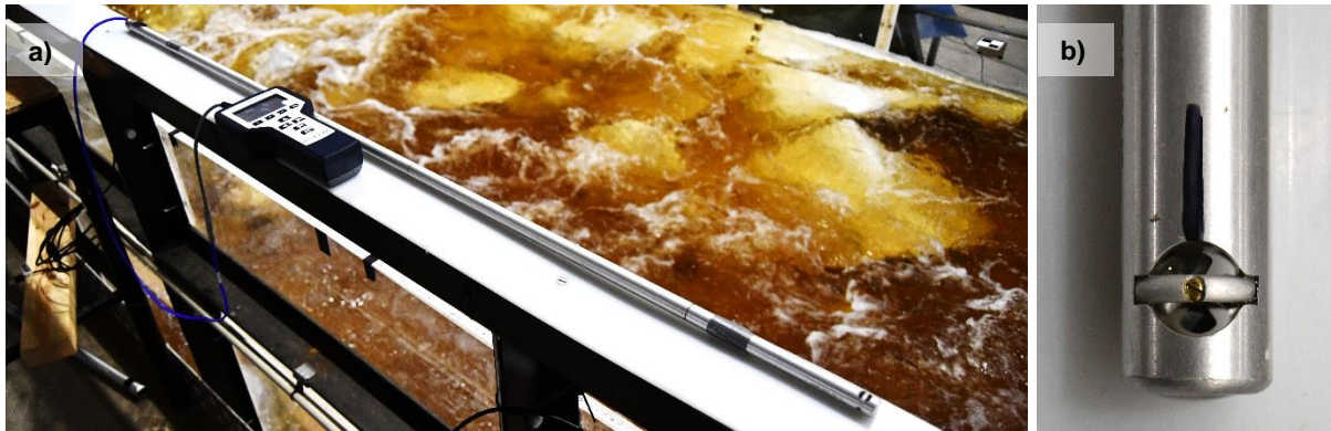
Abb. 3.35 Hydrometrischer Flügel. a) Hötzsch Flowtherm NT.2 Handgerät sowie Sonde mit Anschlusskabel; b) Sondenkopf mit Propeller. (Aufnahmen: Eikenberg)
