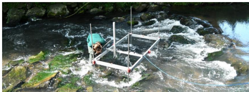
Abb. 3.12 Messrahmen für die ADV-Messungen im Feld (Aufnahme: Eikenberg)
