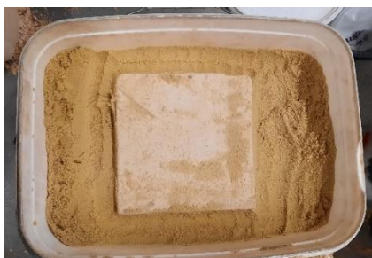
Abbildung 15-31: Eiskern Block im Form Sand
