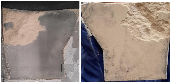
Abbildung 15-42: Viertelkern ohne Trennmittel
