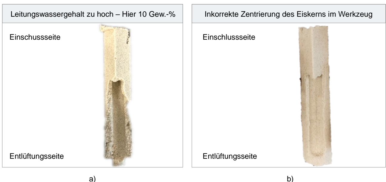
Abbildung 9-16: Exemplarische Herstellungsfehler bei der Hohlkernfertigung.
