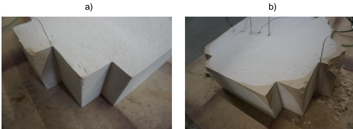
Abbildung 15-23: Kern nach Tauzeit a) 20 Minuten b) 60 Minuten
