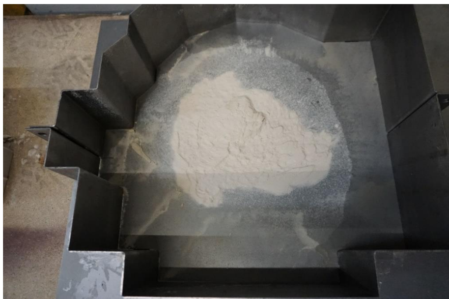
Abbildung 15-17: Ausbruch am Boden der Blechform
