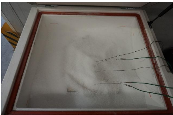
Abbildung 15-15: a) Form im Container b) Messung der Temperaturverläufe
