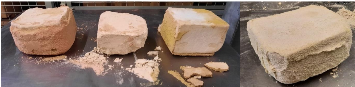
Abbildung 15-32: Schalenbildung verschiedener Eiskerne im Formsand (Von links nach rechts Versuch 1 – 4 Tabelle 15-10)
