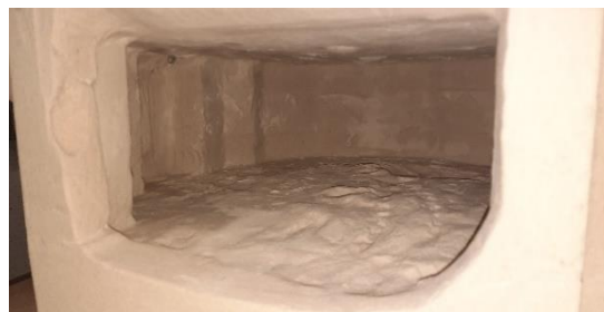
Abbildung 15-27: Hohlkern, a) Aussaugen des losen Sandes, b) Innenraum Hohlkern
