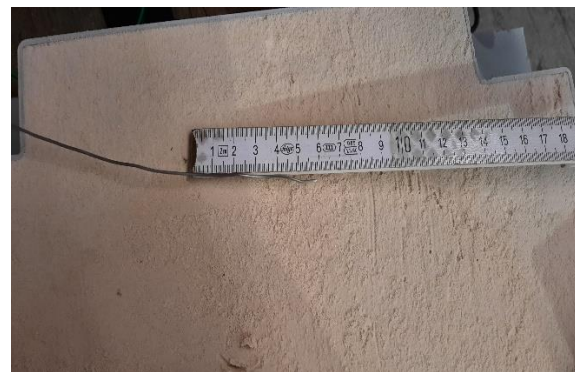
Abbildung 15-14: a) Staffelung Thermoelemente b) Thermoelement auf 6 cm abgemessen
