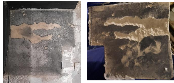
Abbildung 15-43: Viertelkern mit Graphitspray
