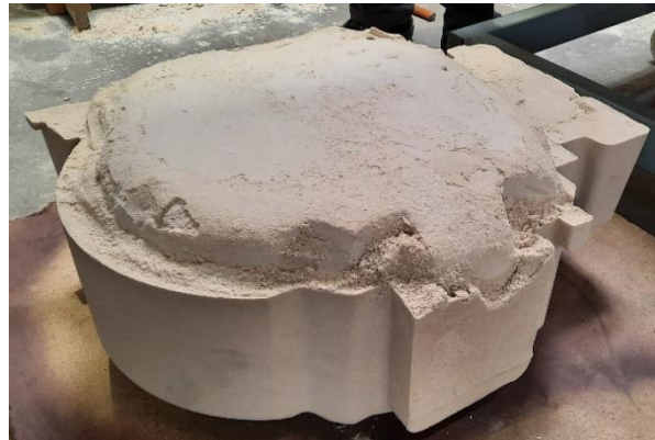
Abbildung 15-30: Kern genau an der Verdichtungsschicht des Unterkastens gerissen
