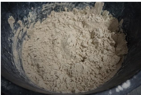
Abbildung 15-11: Sand Wasser Gemisch mit 3%-Wasseranteil
