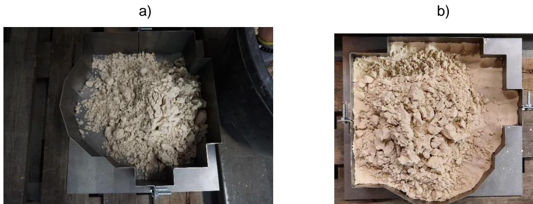
Abbildung 15-12: a) lose eingefüllter Sand b) Sand vorverdichtet
