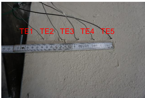
Abbildung 15-14: a) Staffelung Thermoelemente b) Thermoelement auf 6 cm abgemessen
