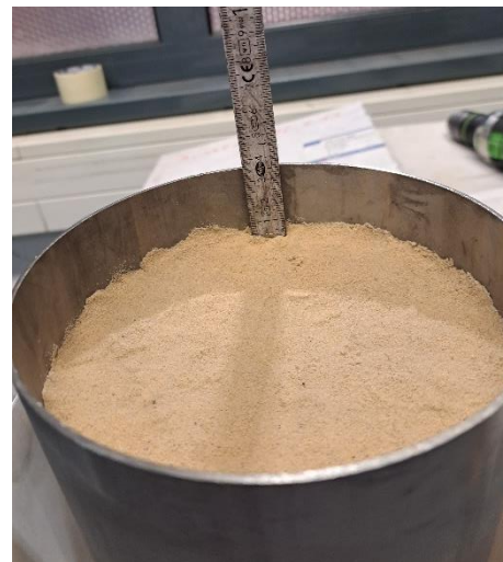
Abbildung 15-5: a) Mischung mit Akkuschauber b) Verdichtung und Überprüfung der Höhe
