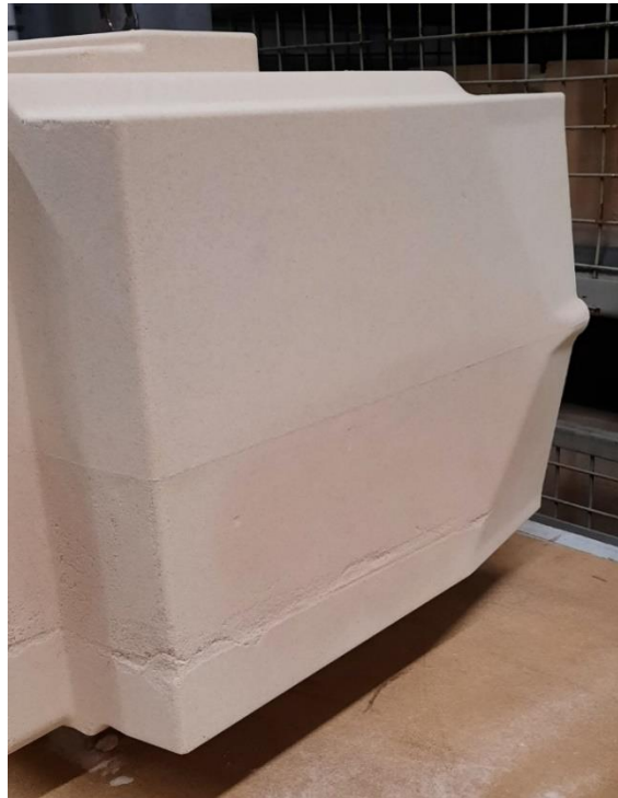
Abbildung 15-29: Hohlkern mit feuchtem Fleck nach einer Nacht Tabelle 15-9: Einsparung Formstoff im Vergleich zwischen klassischem Hohlformer und Eiskernverfahren am Beispiel des Serienbauteils
