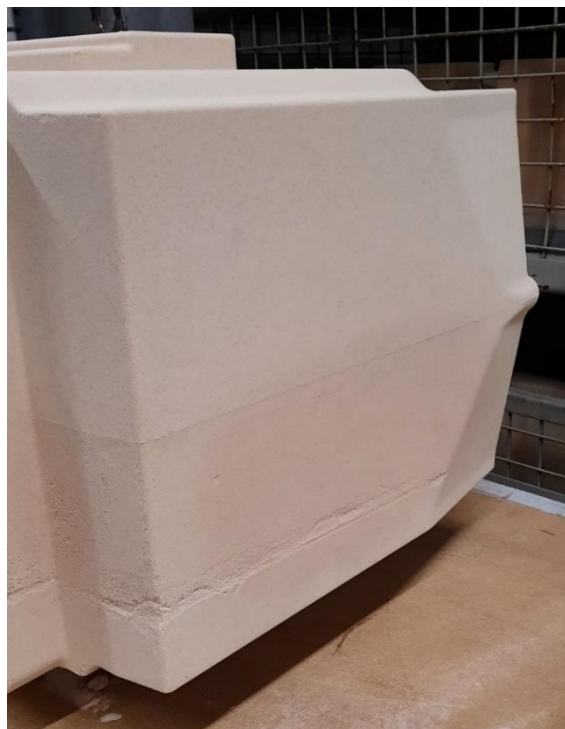
Abbildung 15-29: Hohlkern mit feuchtem Fleck nach einer Nacht
