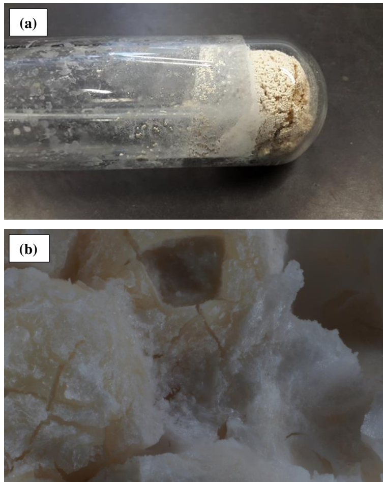
Abbildung 7 - Mikroskopaufnahme der Aluminiumoxidkugeln, die mit Vanadiumpentoxid (1,65 mM) in Salpetersäurelösung imprägniert wurden : (a) zusammengeklebte Partikel nach Beendigung der Imprägnierung im Mikrowellensystem; (b) durch Salpetersäure zerstörte Oberfläche der Aluminiumoxidkugeln
