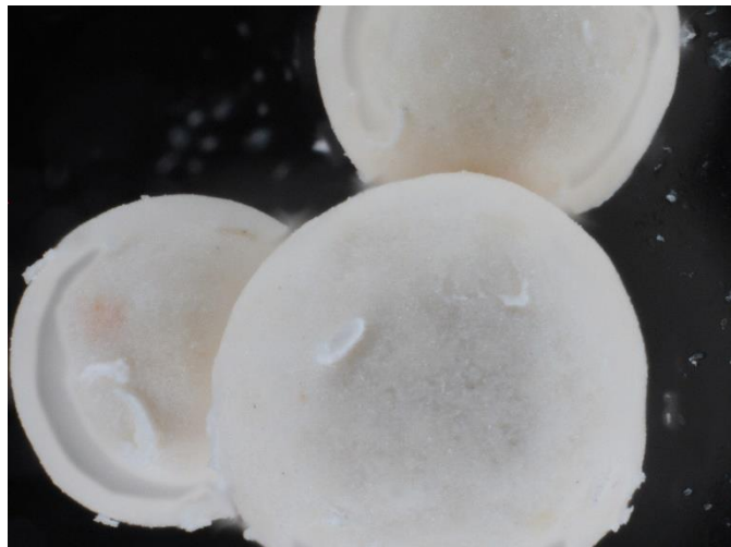
Abbildung 10 - Aluminiumoxidkugeln, die mit Salpetersäure 0,15 mM und Mikrowellenenergie ausgesetzt wurden
