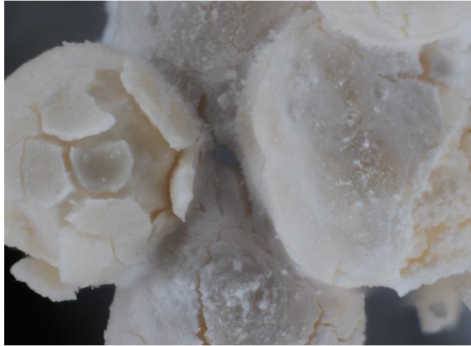
Abbildung 9 - Aluminiumoxidkugeln, die mit Salpetersäure 1,55 mM und Mikrowellenerwärmung ausgesetzt wurden
