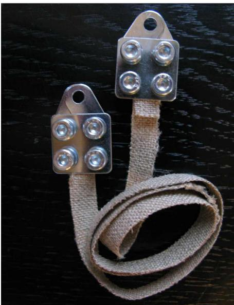
Bild 10: Zugprobe mit Einspannung
