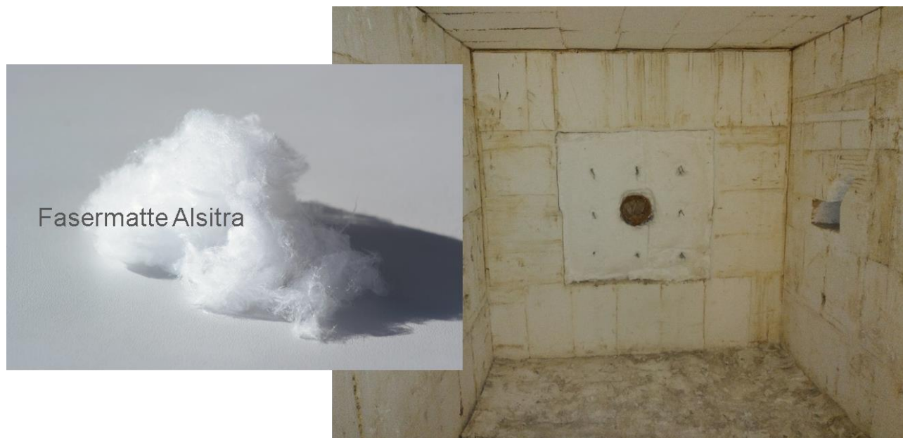
Abbildung 12: Unbeschichtete Brennkammer, zugestellt mit Alsitra 1.600 Fasermatte
