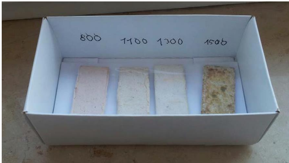
Abbildung 10: Coating nach Erwärmung auf verschiedenen Temperaturen
