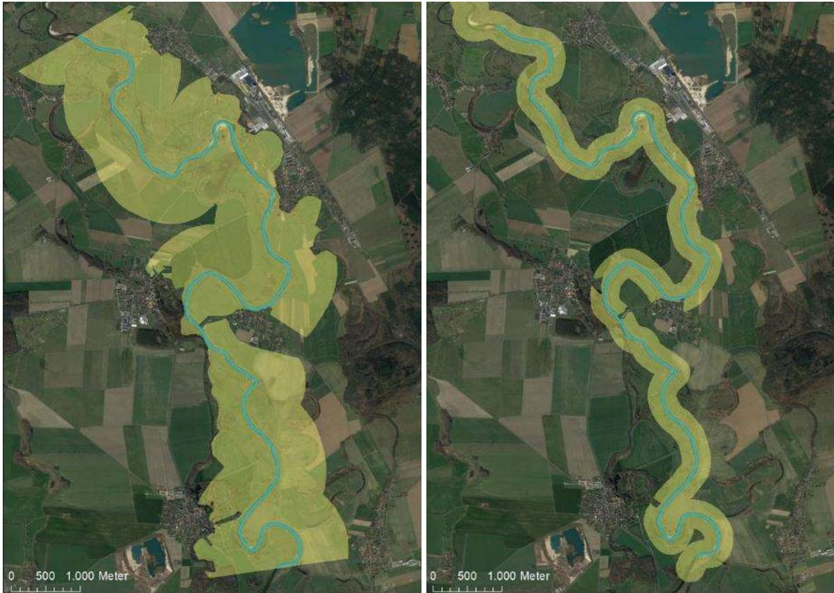
Abbildung 12: Der maximale (links) und der minimale (rechts) Entwicklungskorridor an der Mulde im Projektgebiet nach der Methode des Umweltbundesamtes (Dahm et al. 2014).
