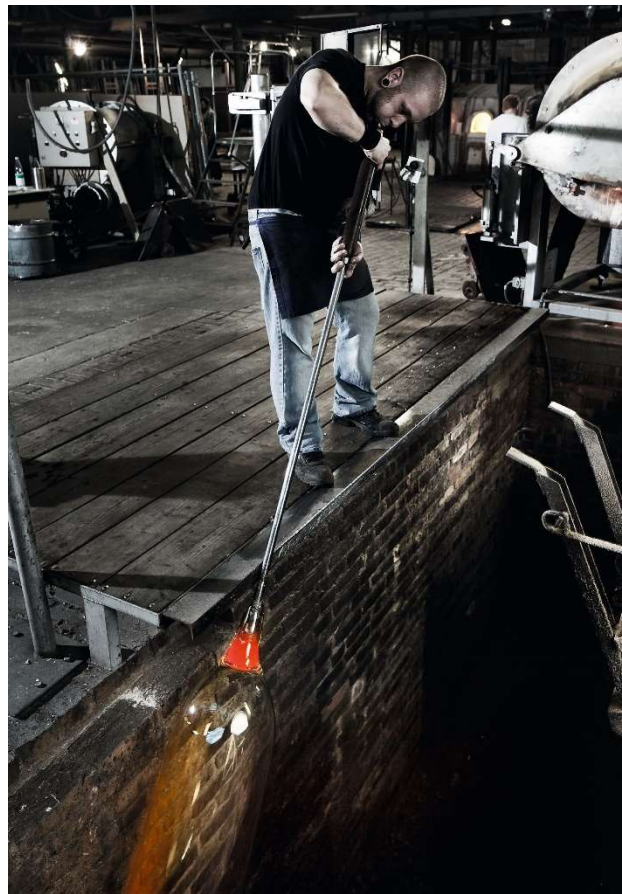
Abb. 3: Produktion von mundgeblasenem Flachglas in Neu-Antik-Technik
