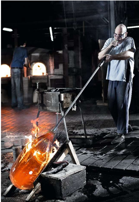
Abb. 4: Produktion von mundgeblasenem Flachglas in Echt-Antik-Technik
