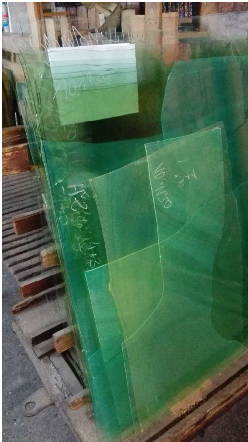
Abb. 2: UV-IR-Glastafeln nach dem Strecken der Glaszylinder
