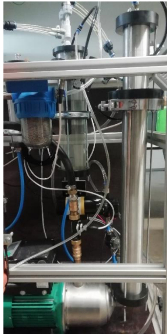
Abbildung 12: Wirbelrohr-Entgaser mit Vakuumpumpe - Frontansicht
