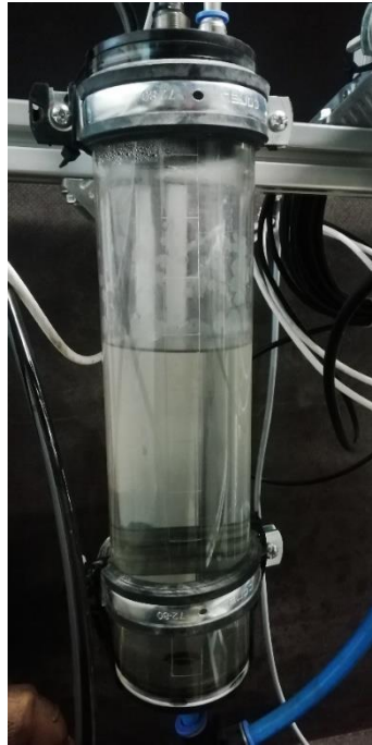
Abbildung 14: Gas-Volumenstrommessung mittels Gasmessglocke
