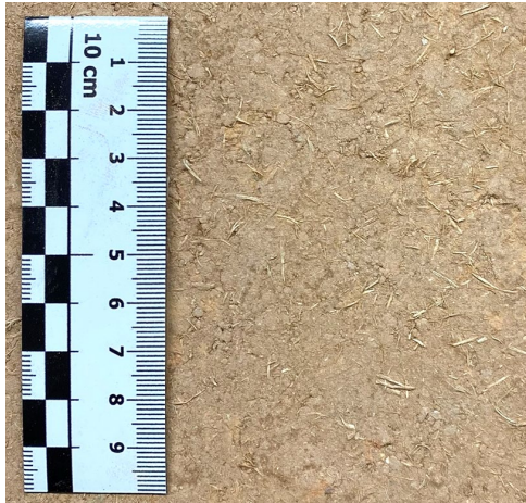
Abbildung 62: Oberflächenbeschaffenheit Lehm- platte
