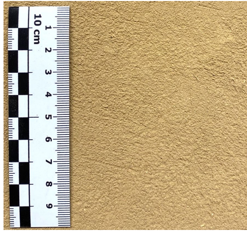
Abbildung 63: Oberflächenbeschaffenheit Lehm- platte mit Lehmfeinputz
