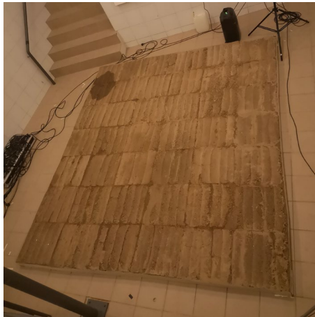
Abbildung 38: Prüffläche im Hallraum des ETI Messkampagne 2
