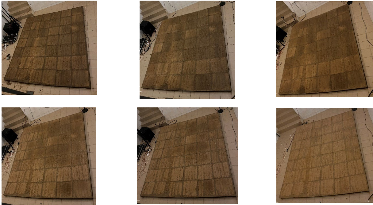
Abbildung 39: Stampflehmoberfläche in verschiedenen Trockenstadien der Messkampagne 1
