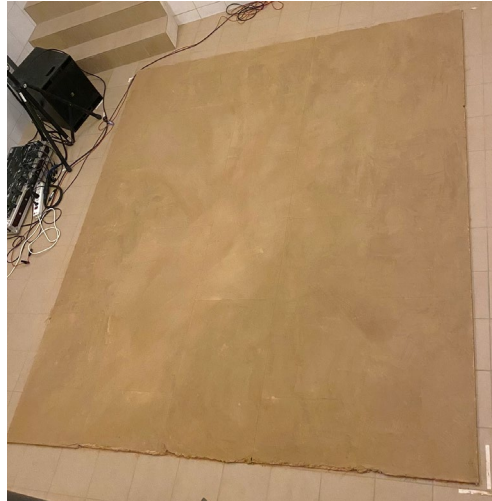
Abbildung 61: Lehmbauplatte mit Lehmfeinputz
