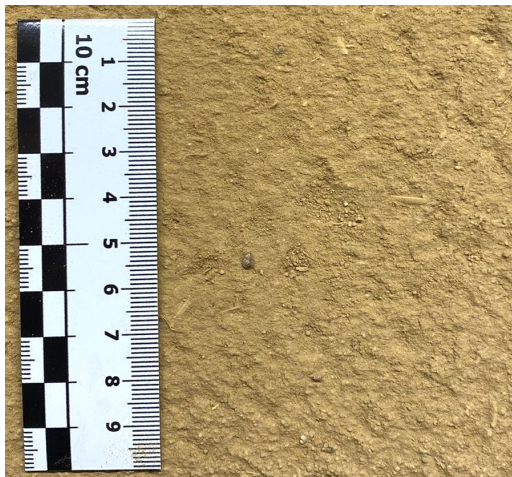
Abbildung 57: Oberflächenbeschaffenheit veränderter Lehmoberputz – Nadelrolle
