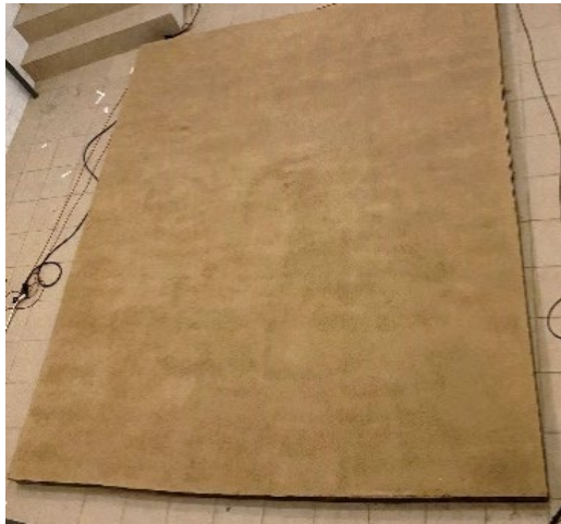
Abbildung 55: Lehmverputzte Oberfläche, bearbeitet mit einer Nadelrolle
