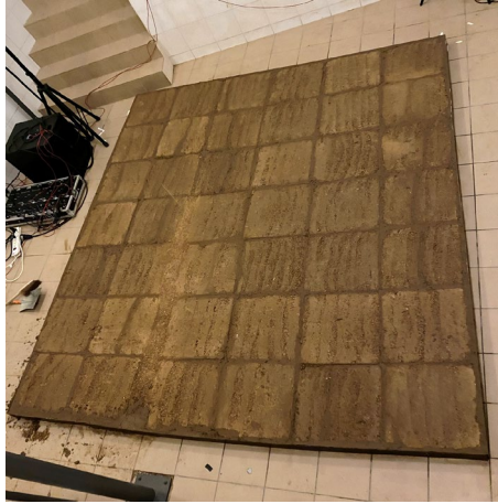
Abbildung 36: Prüffläche im Hallraum des ETI Messkampagne 1
