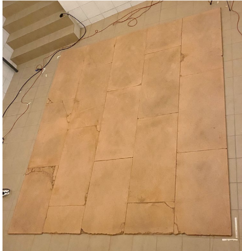
Abbildung 60: Lehmbauplatten Oberfläche unbehandelt
