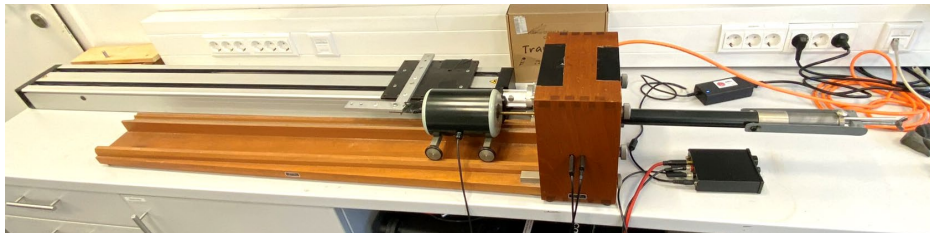
Abbildung 69: Schallimpedanzrohr inkl. Lautsprecher, Schlitten, ISEL mit kreisrundem Prüflingshalter ( d_s = 29 mm)
