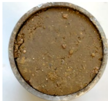
Abbildung 68: Probe mit einem Durchmesser von 29 mm im feuchten Zustand
