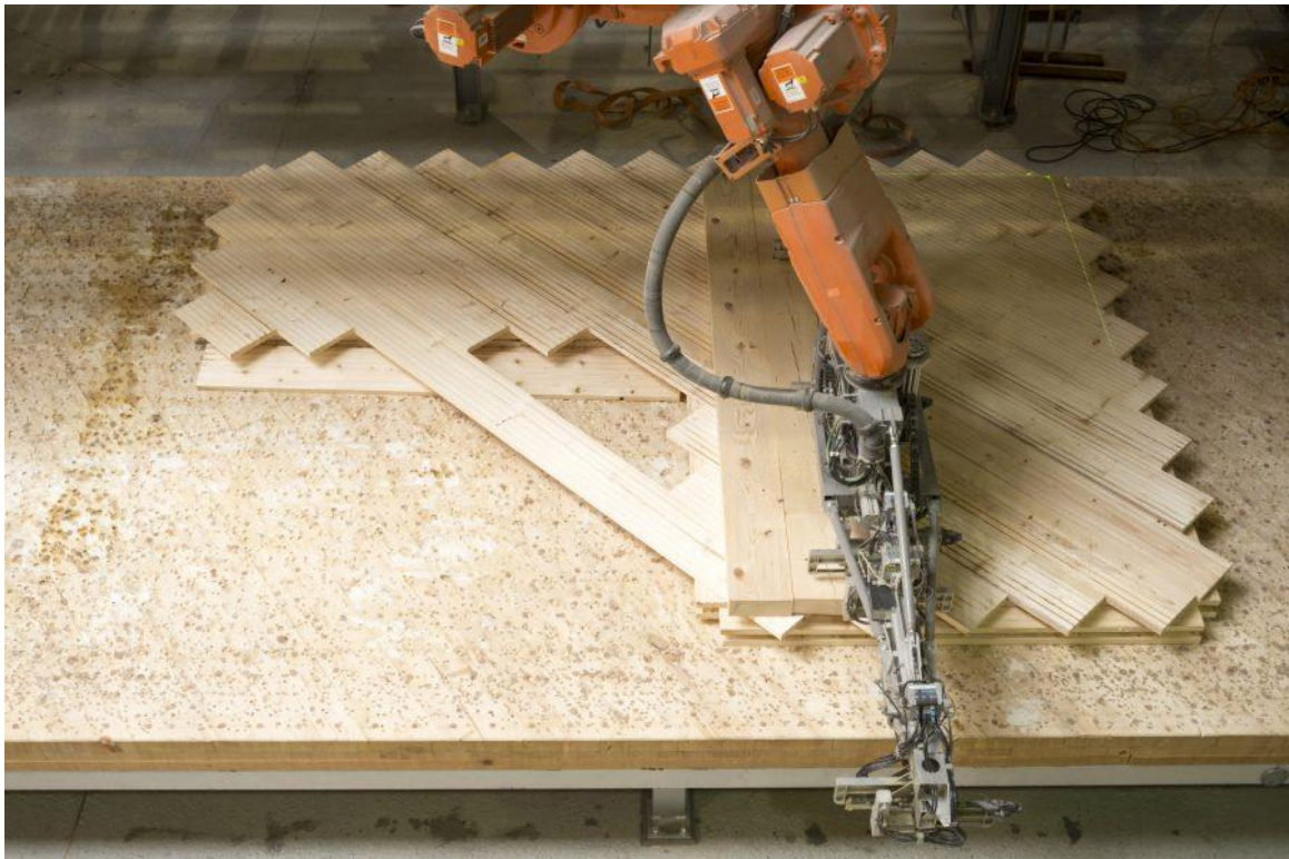
Abbildung A1.19: Holz100, Roboter bei Herstellung von einstofflicher Massivholzwand [Foto: 2020 Thoma Holz GmbH]
