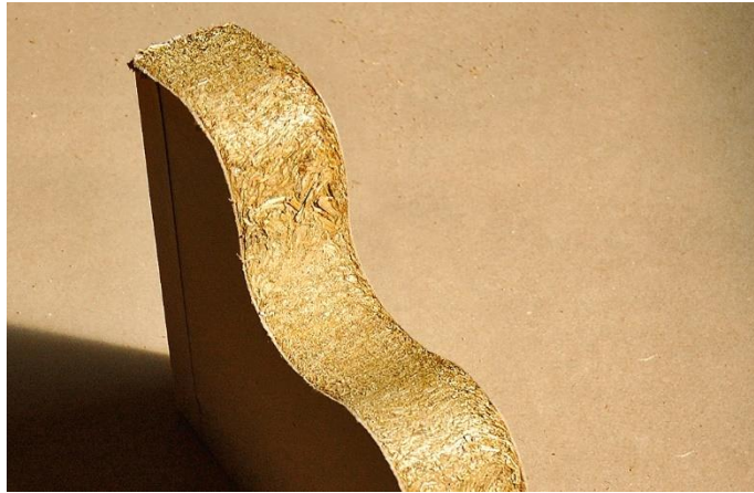
Abbildung A1.46: Strohbauplatte [istraw.]
