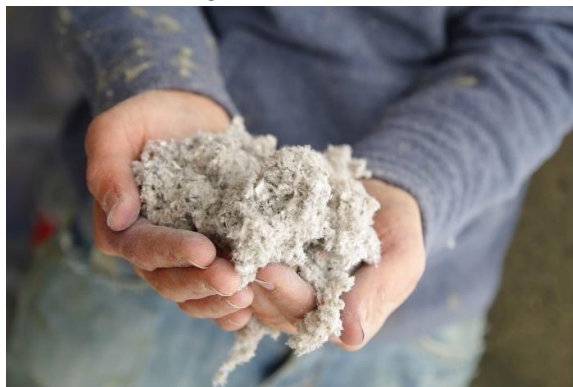
Abbildung A1.36: Zelluloseflocken aus Altpapier [minicel73 / Adobe Stock.]
