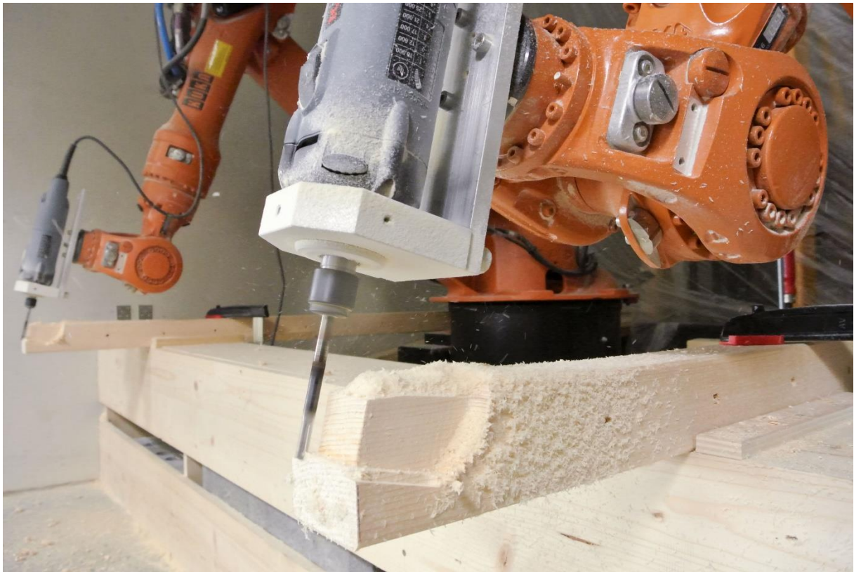
Abbildung A1.17: Holzbearbeitung durch computergesteuerte Roboter [Robotics in Architecture]
