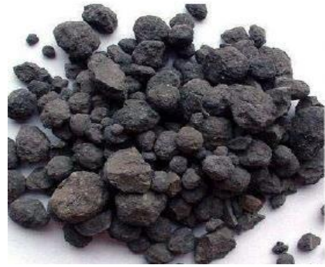
Abbildung A3.11: Zementklinker nach dem Brennen
