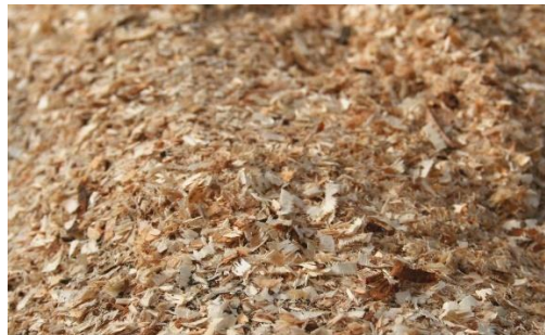
Abbildung A1.42: Einblasdämmung aus Holzspänen [Wikimedia, Przykuta.]
