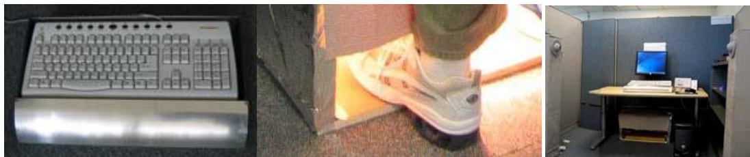
Abbildung 25: TAC (Tastatur, Infrarotfußwärmer und Kopfventilation) [Zhang et al. 2009: 2]
