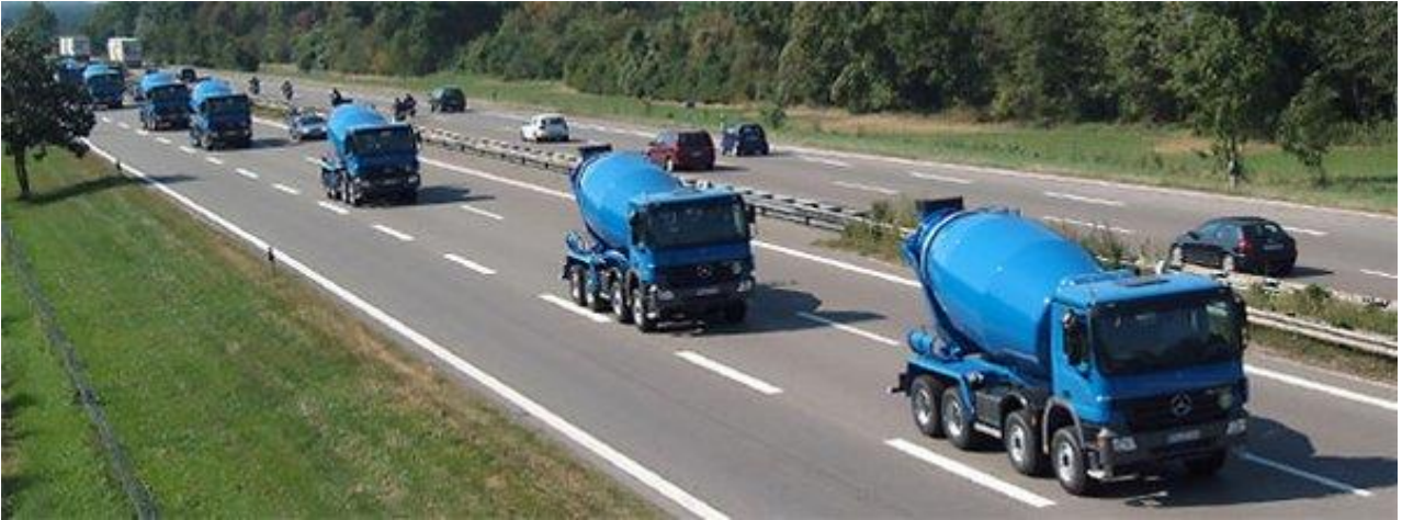
Abbildung A3.5: Transportbeispiel Fahrmischer für Ortbeton [ohne Quelle]
