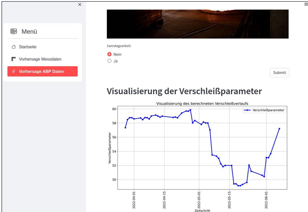
**Abb. 12:** Visualisierung des Verschleißverlaufs anhand elektrischer Daten
