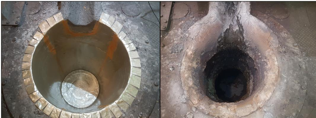
**Abb. 8:** Verschleiß eines Schmelztiegels
