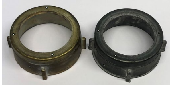
Abbildung 10: Nassläuferkopf aus CuZn39Pb3 (links) und aus ZEP1510 (rechts)
