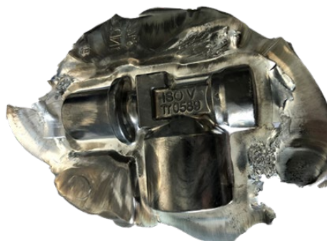
Abbildung 12: geschmiedetes Ventilkörperrohling mit Grat aus Zinknetlegierung ZEP1510
