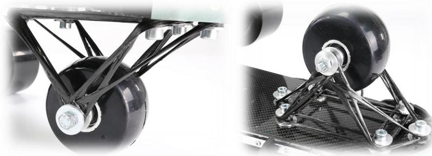
Abbildung 16: Die mit Carbonfasern gewickelte Hinterachse im endmontierten Zustand.
