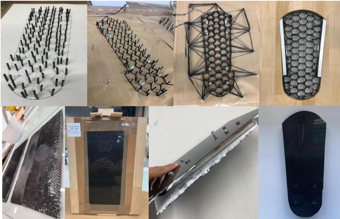
Abbildung 13: Der Herstellungsprozess der aus Carbonfaser gewickelten Wabenstruktur. Material bereitgestellt und hergestellt an den DITF in Denkendorf.
