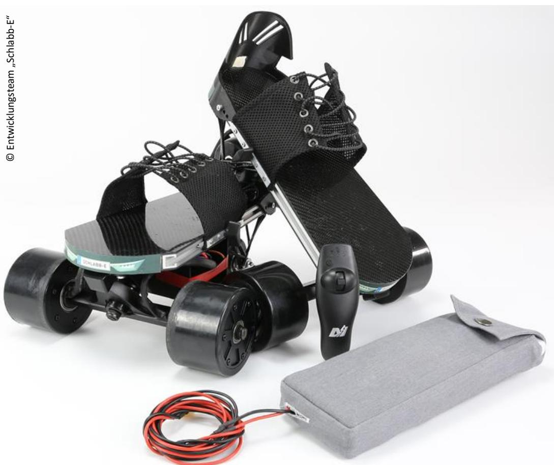
Abbildung 17: Der Schlabb-E als Gesamtsystem bestehend aus zwei Rollschuhen, davon einer elektrisch angetrieben, einem externen Akku mit Klipp für den Hosenbund und Fernbedienung zur Ansteuerung der Antriebsachse.
