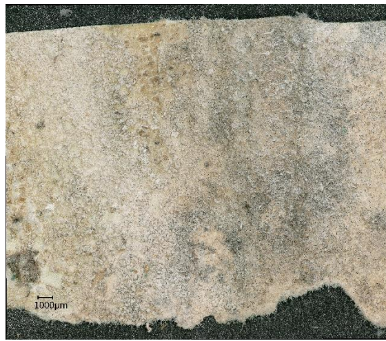
Abb. 4: Partikelprobe 1 – Unterseite. Probenstück der Tapete mit Klebespuren an der Unterseite. DM
