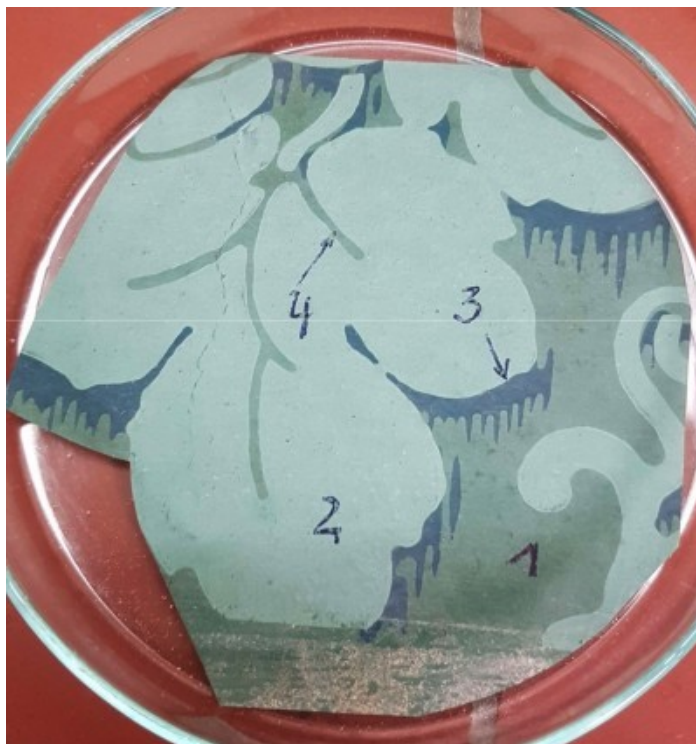
Abb. 8 Tapetenabschnitt zur Bestimmung der As-Konzentration
