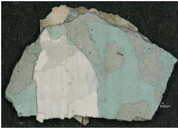
Abb. 1: Partikelprobe 1 – Oberseite. Mehrere Farbschichten. DM
