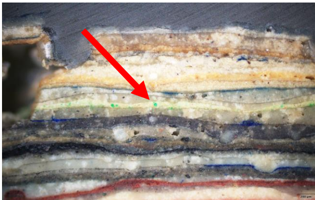
Abb.1-2: Querschliff und Querbruch. grüne Malschicht, lichtmikroskopisch Hinweis auf Schweinfurter Grün. OM/DF-DM
