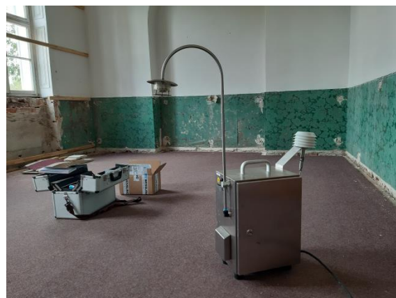
Abb. 19 Messung von Schwermetallen in Staub
