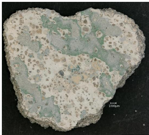
Abb. 1: Partikelprobe 1 – Oberseite. Grüne Schicht auf Kalkmörtel. DM
