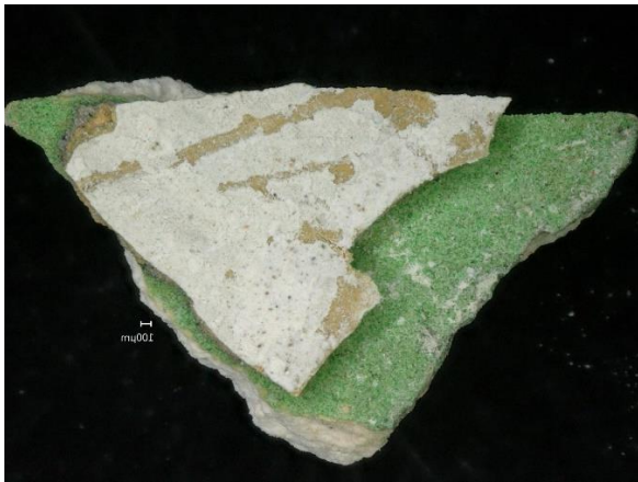
Abb. 1: Partikelprobe 1 – Oberseite. Grüne Schicht eingebettet in Schichtpaket. DM
