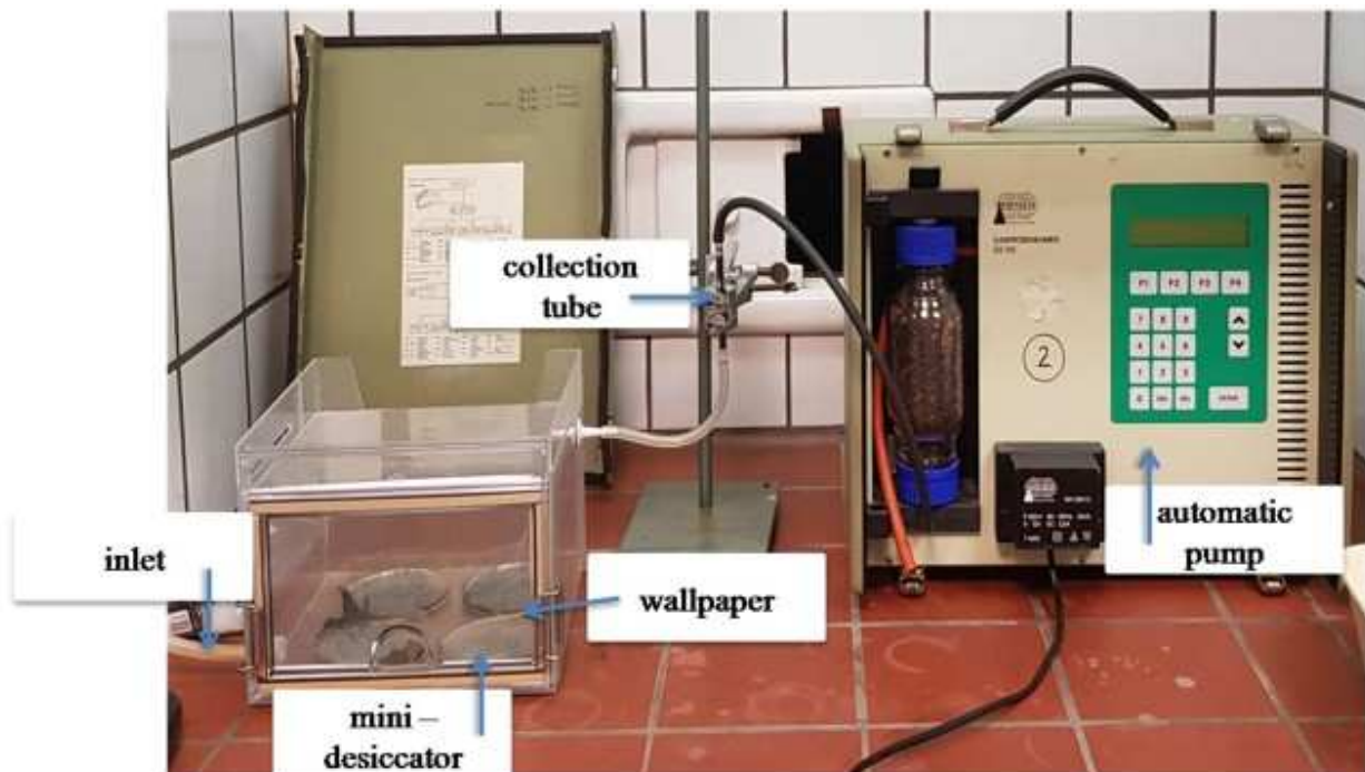
Abb. 5 Versuchsaufbau zur Anreicherung flüchtiger As-Verbindungen
