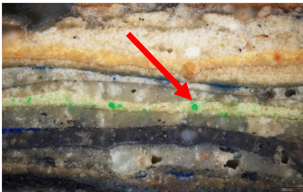
Abb. 3-4: Querschliffdetail. Grüne Partikel deutlich sichtbar, charakteristisches Aussehen von SG. OM/DF-UV
