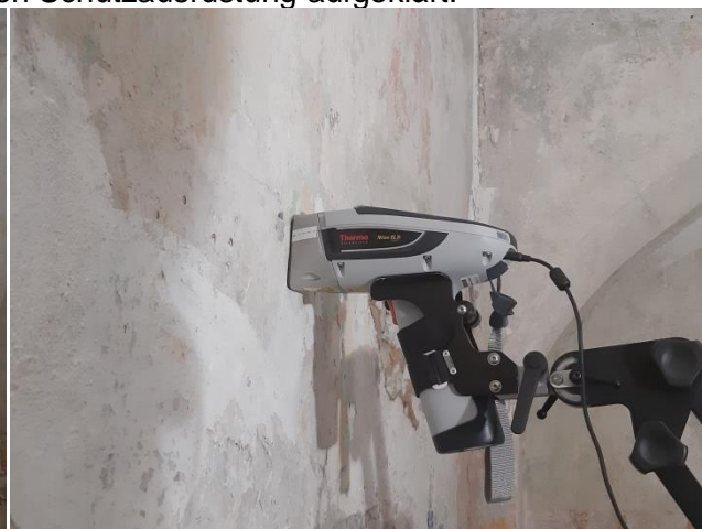
Abb. 9 Analyse mit mobiler RFA
