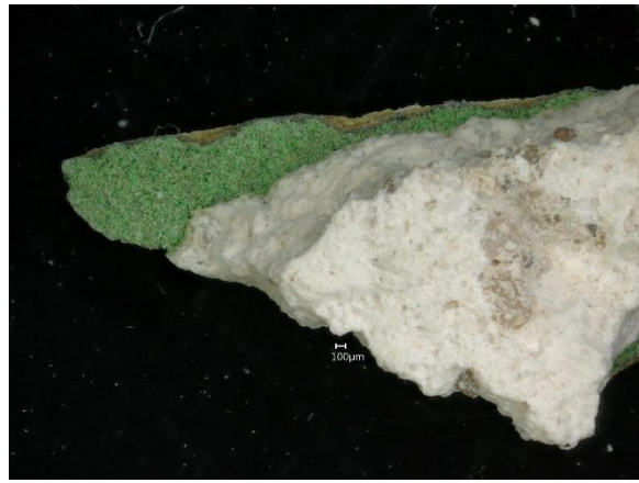
Abb. 2: Partikelprobe 2 - Unterseite: Grüne Schicht in Schichtpaket auf Putzträger. DM
