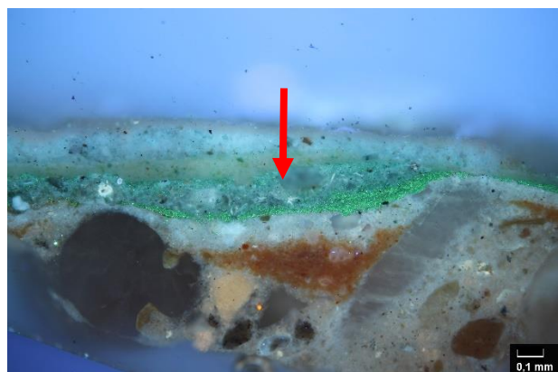
Abb.4-5: Querschliff. grüne Malschichten, lichtmikroskopisch kein Hinweis auf Schweinfurter Grün. OM/DF-UV
