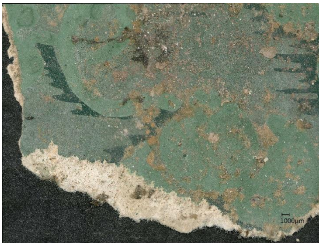
Abb. 1: Partikelprobe 1 – Oberseite: Bedruckte, mehrfarbige Tapete. DM
