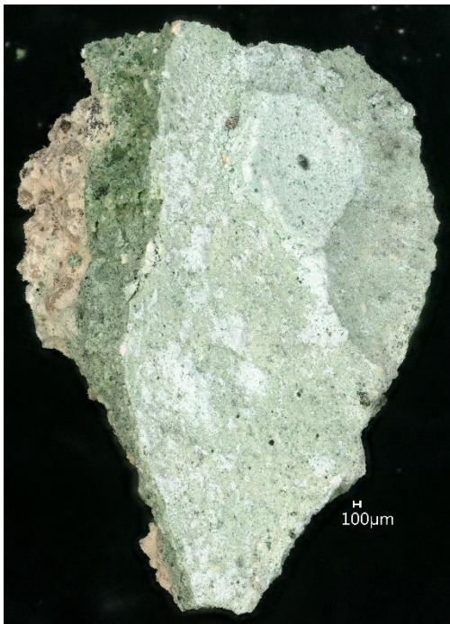
Abb. 3: Partikelprobe 1 –Oberseite. Komplexes Schichtpaket. DM
