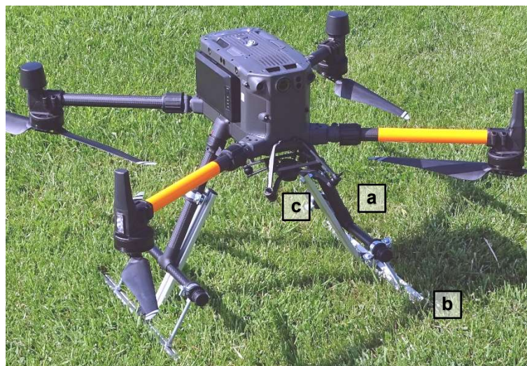
Abbildung 8: Drohne DJI M300 mit: (a) Originalem Landegestell mit (b) prototypischer Landegestellverlängerung und (c) DJI Schnellverschluss mit gedämpfter Halterung
