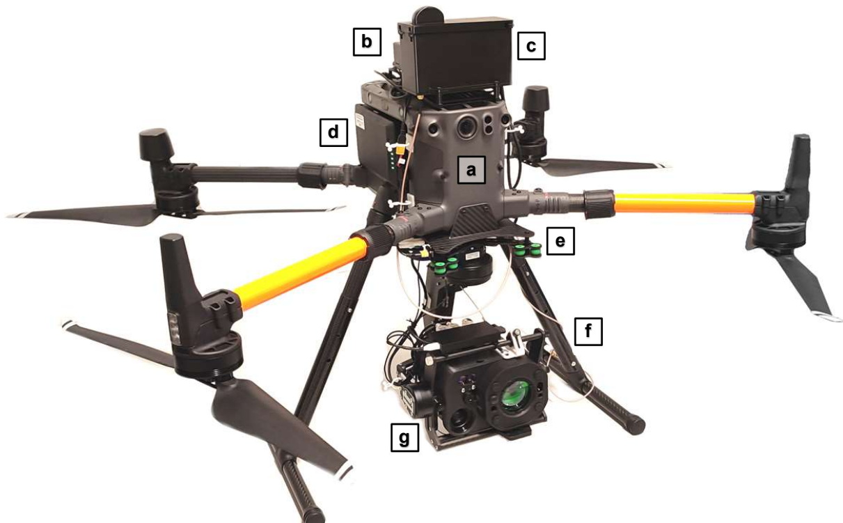
Abbildung 9: (a) Drohne DJI M300 mit (b) Bordcomputer, (c) Zusatzkomponentengehäuse, (d) TB60-Akkus, (e) Adapterplatte für Gimbal, (f) verlängertem Landegestell und (g) Messmodul
