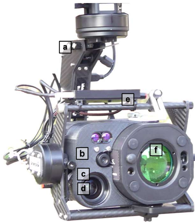
Abbildung 7: Messmodul bestehend aus: (a) Gimbal, (b) Distanzsensor, (c) Übersichtskamera, (d) Detailkamera, (e) USB-Hub, (f) TDLAS und Gehäuse
