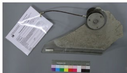
Olympiadach 1972, BLfD Inv.-Nr. 2769, 4 mm, Puffer Chloropren
