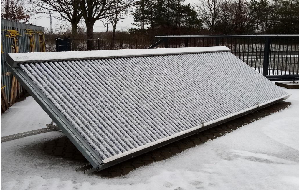
Abbildung 18: Schnee, der das gesamte Kollektorsegment bedeckt.
