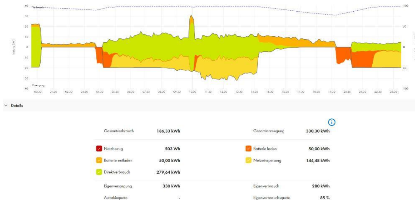
Abbildung 31 Darstellung des Netzbezuges, Erzeugung und Eigenverbrauch an einem Wintertag 16.02.2021 mit Batterie
