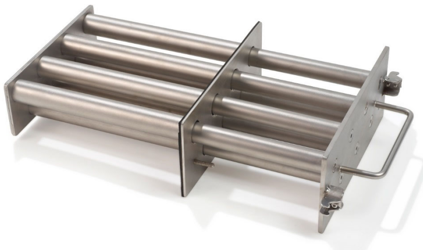
Abbildung 1. Foto eines Magnetgitters. Die sehr starken Magneten sorgen für eine gute Anlagerung der magnetischen Partikel. Durch das Mantelsystem können die Magneten leicht entfernt und der Magnetabscheider so gereinigt werden.
