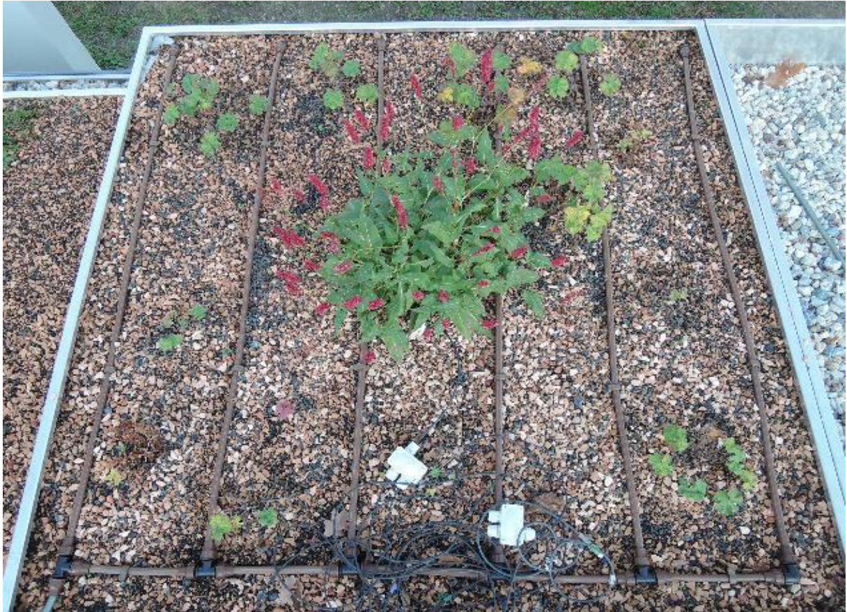
Abbildung 2.1-8: Eingebaute Tröpfchenbewässerung in Forschungsfeld FII.2 an Standort II.
