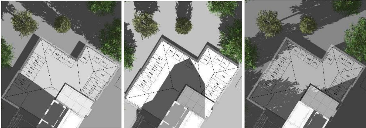
Abbildung 2.2-1: Schattendiagramm aus 3D-Modell mit Sonnenverlauf für Dresden am 30. März um 9:00, 12:00 und 16:00.
