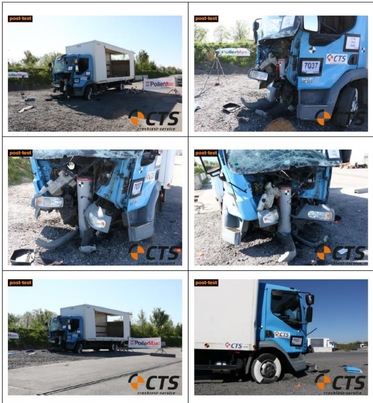
Abbildung 33 Crashtestergebnis (zerlegter LKW)
