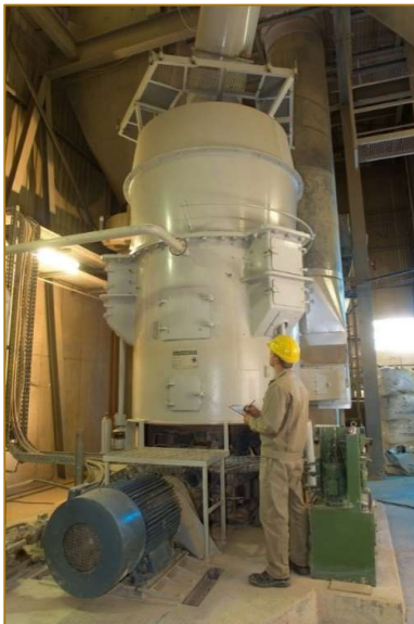
Walzenschüsselmühle (Bild rechts aus https://www.gebr-pfeiffer.com/produkte/mvr-walzenschuessel-muehle-multidrive )
