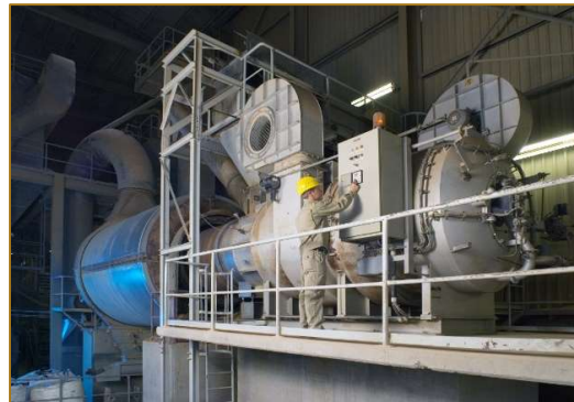
Aufbereitung: Links: Kastenbeschicker (Vorzerkleinern und Homogenisieren); rechts Trockner
