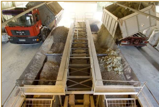
Aufbereitung: Links: Kastenbeschicker (Vorzerkleinern und Homogenisieren); rechts Trockner
