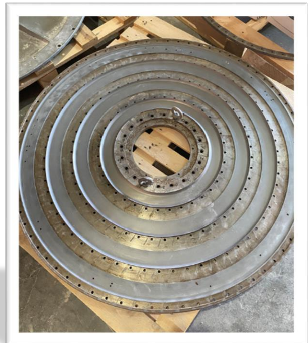
Abbildung 2 Untere und obere Prallscheibe der Prallmühle Nr. 4 bei einer Wartungsbesichtigung
