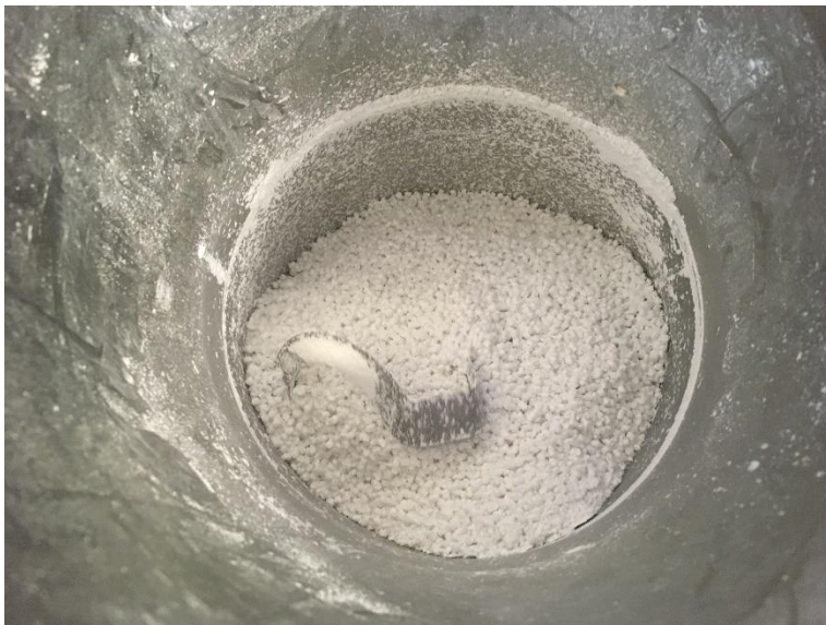
Abbildung 14 Vorlagebehälter des Compoundierextruders mit der Talkum-Polymer-Vormischung
