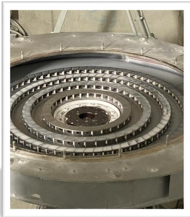
Abbildung 2 Untere und obere Prallscheibe der Prallmühle Nr. 4 bei einer Wartungsbesichtigung
