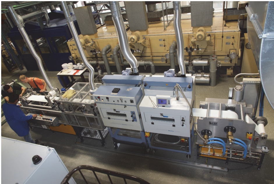
Abbildung 14: Halbtechnische Versuche zu PVC-Streichverfahren am FILK Freiberg Institute gGmbH (Quelle: B. Trommer, Freiberg)
