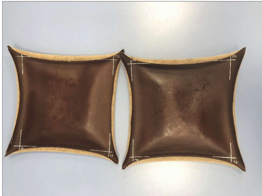
Abbildung 6: Nuvi Releaf nach Alterungssimulation in Klimakammer
