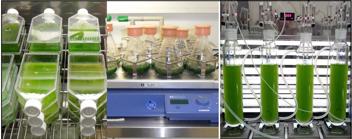
Abbildung 1: Phototrophe Laborkulturen in Zellkulturflaschen (links), in Schüttelkolben (mittig) und in Blasensäulenreaktoren (rechts).
