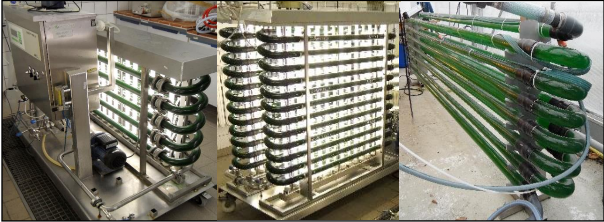
Abbildung 3: Kulturen der Mikroalge Cyanidium caldarium in 3 Glasröhren-Photobioreaktoren der IGV GmbH: 30 L unter Kunstlicht (links), 100 L unter Kunstlicht (mittig) und ca. 100 L unter Witterungseinfluss in einem Gewächshaus (rechts).
