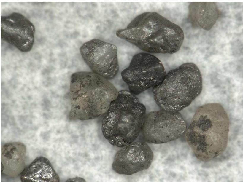
Abbildung 12: Mikroskopaufnahme (Auflicht, 100-fache Vergrößerung) von aufbereitetem Altsand von Altsand 1
