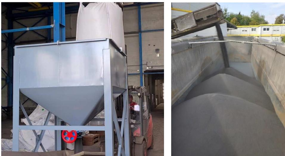
Abbildung 7: Verladung Fertigsand; linkes Bild: Verladetrichter; rechtes Bild: Befüllung in LKW
