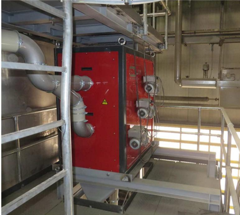
Abbildung 4: Magnetabscheider
