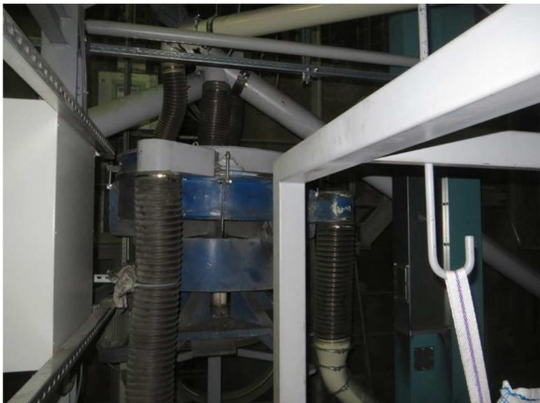
Abbildung 1: Kreisschwingsieb
