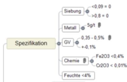
Unsere Analysen im Chemischen Labor bestätigen die Einhaltung dieser Spezifikation. Bei der Siebung konnte Material im Unterkorn bis 0,5% festgestellt werden. Dies führte bei der Entladung zu einer sehr starken Staubentwicklung. Überkorn gab es keines.
