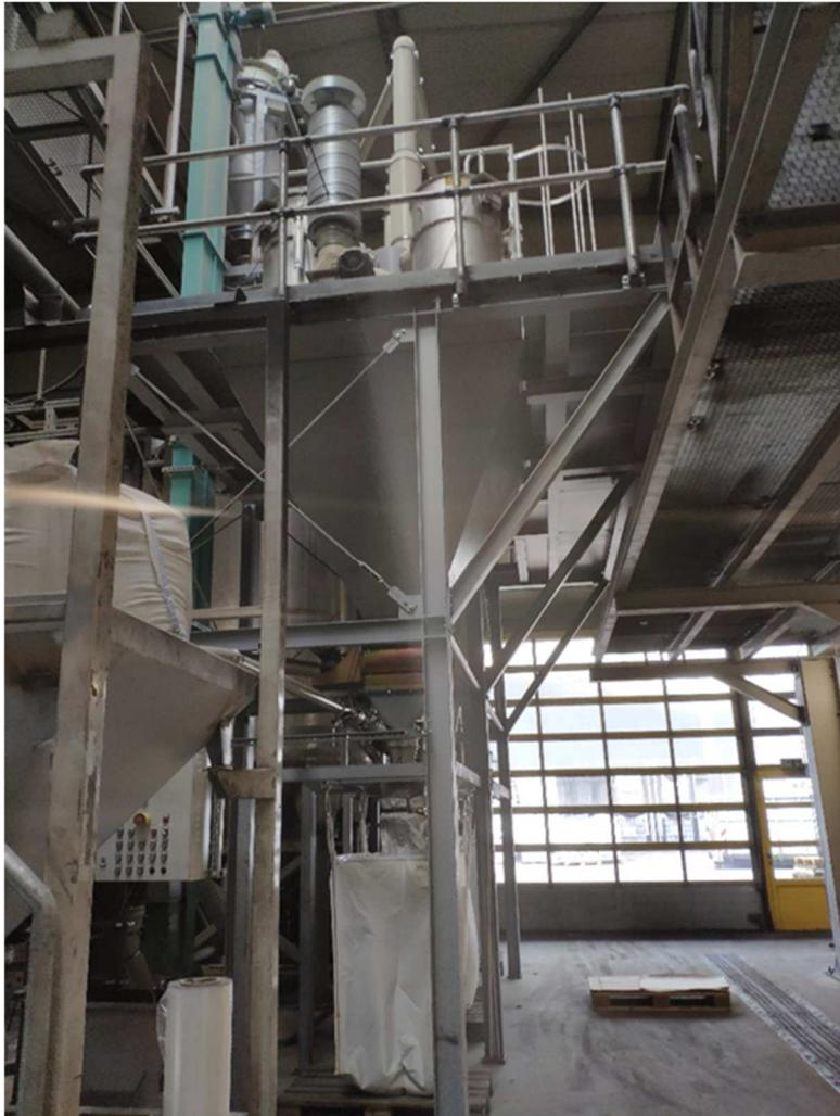
*Abbildung 3: Entstaubungsanlage mit Big-Bag Befüllung*
