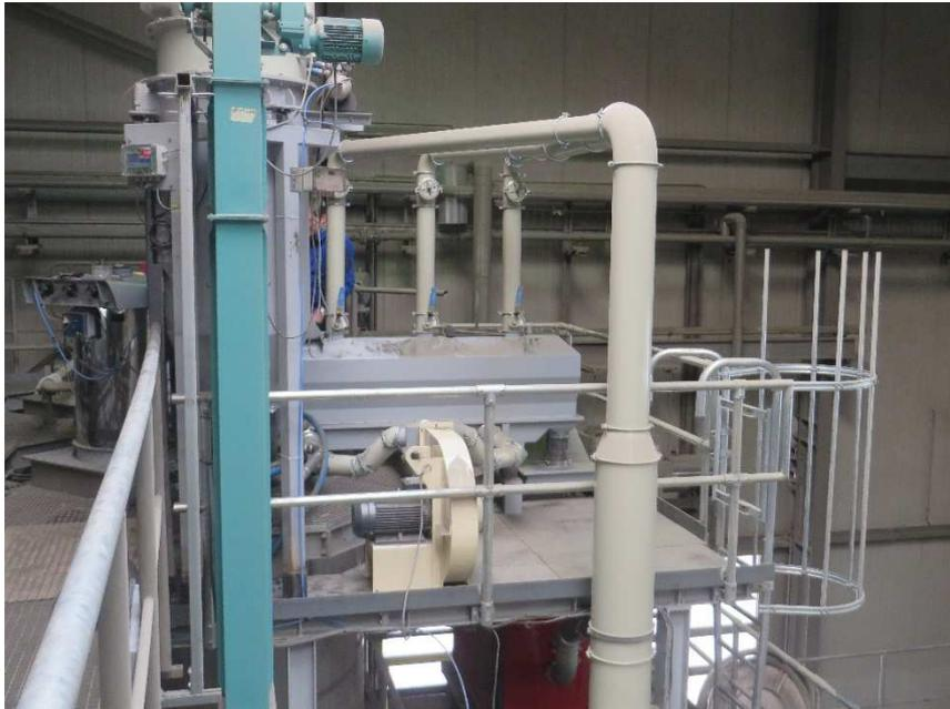
Abbildung 2: Elevator, Luftstrahlmühle, Fließbettsichter
