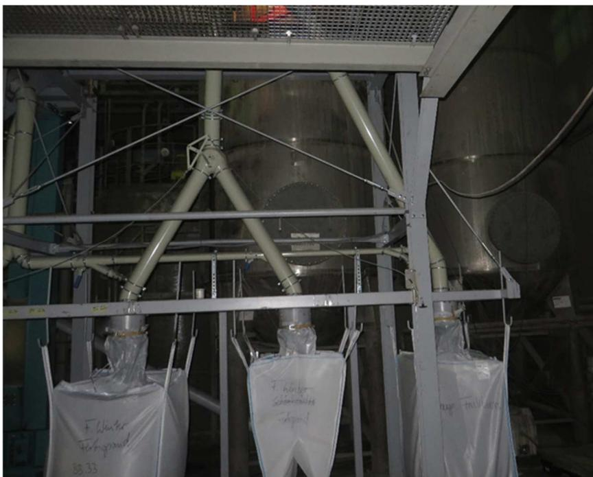
Abbildung 5: Big-Bag Befüllung (links: Fertigsand Befüllung; Mitte: Fertigsand leer; rechts: magnetische Fraktion Befüllung)
