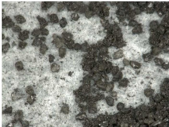
Abbildung 13: Mikroskopaufnahme (Auflicht, 100-fache Vergrößerung) der Körnung 125-150 µm einer Feinfraktion (nach Siebung)
