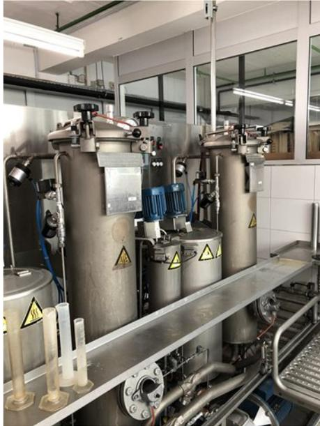
Abbildung 3: Laborfärbeapparate bei ST
