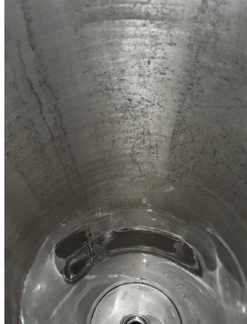
Abbildung 14: Anschmutzung des Färbeapparats nach der Enzymbehandlung und nach dem Auskochprozess
