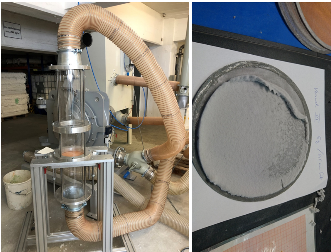
Abbildung 24: Versuchsanordnung zur Feinstoffabtrennung nach der Trockenzerfaserung
