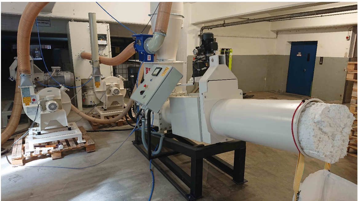
Abbildung 7: Einsatz der mobilen Testanlage DPS 40 GT I bei einem Filterpapierhersteller (1)
