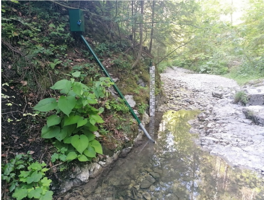
Wasserstandsmessgerät im Bach der Suchá Belá Schlucht
