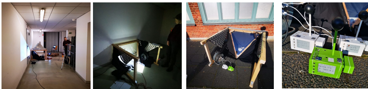
Abb.58 Experimentelle Untersuchung der Lichtintensität des Glases im Innen- und Außenraum, TU Berlin [06]
