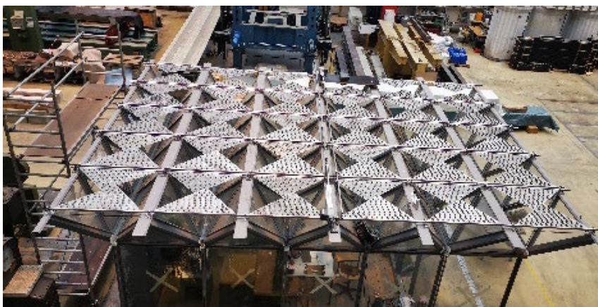
Abb. Aufbau des fertigen Mock-Ups mit wandelbaren Dachverschattungselementen, Versuchshalle TU Berlin
