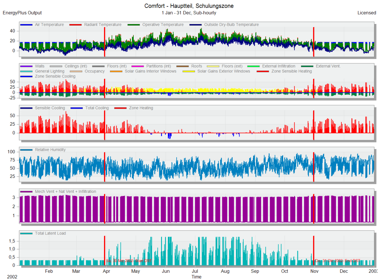
Abb. 3.7 Klimasimulation für Schulungszone mit hohem Heizbedarf und geringer Kühllast wegen Verschattung. In der Schulungszone zeigt sich das wöchentliche Betriebsmuster mit Lüftung und Klimatisierung an Wochentagen.
