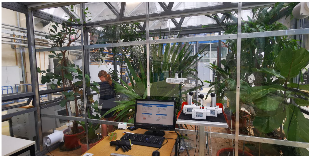
Abb. Messungen mittels BioMet-Messstationen der TU Berlin hinsichtlich Einfluss der Pflanzen auf Temperatur, Luftfeuchtigkeit und CO 2 (Foto, Dirk Peissl, TU Berlin)
