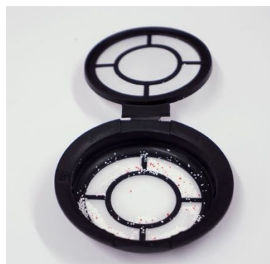
Abbildung 7: Isoliertes Mikroplastik aus einem Peeling-Produkt.
