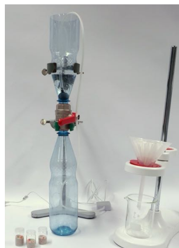
Abbildung 12: Dichte-Trennapparatur in Anlehnung an die wissenschaftliche Methode.
