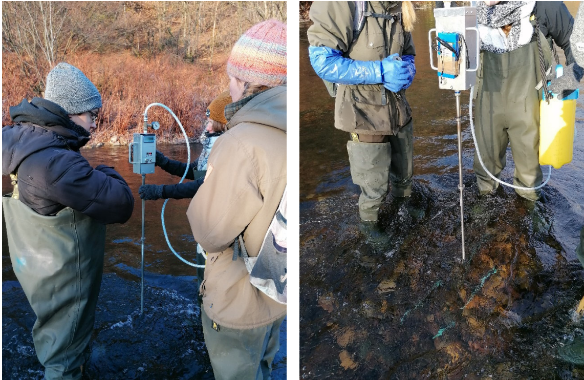
Abbildung 31: Kolmametermessung an einer simulierten Laichgrube am Ende des Expositionszeitraumes. Rechts sind auf der Gewässersohle die Markierschnüre der einzelnen Brutbehälter zu erkennen, die in der simulierten Laichgrube vergraben wurden.
