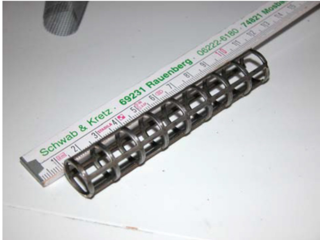
Abbildung 68: Brutröhrchen aus Edelstahl ohne Kunststoffgaze.
