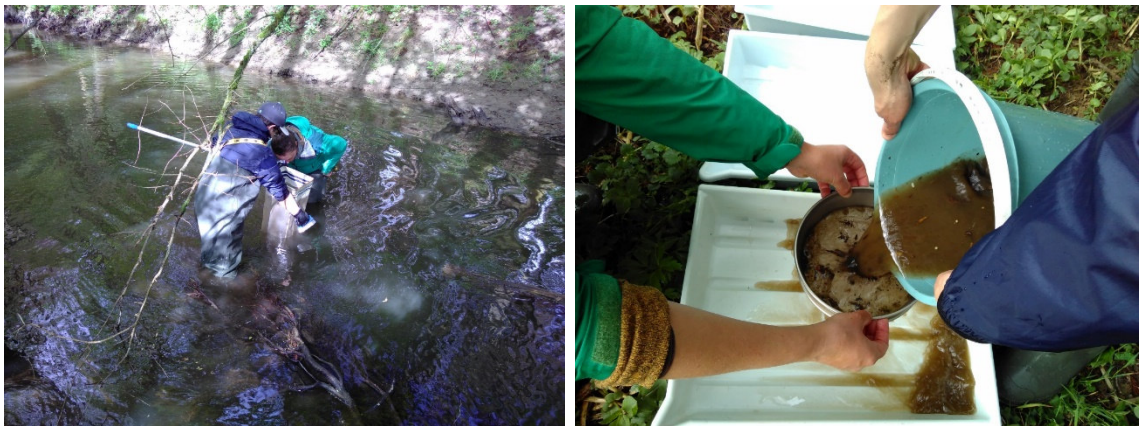
Abbildung 16: Links: Makrozoobenthos-Probenahme im Gewässer. Rechts: Verringerung des Probevolumens durch Aufschwimmen und Sieben der Probe. Foto: Johanna Reineke.
