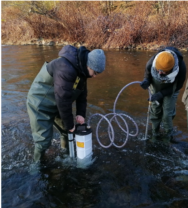
Abbildung 39: Interstitialwasser-Entnahme an Probestelle Agger A-1 (links) und Messung der Leitfähigkeit im Pumpenbehälter (rechts).
