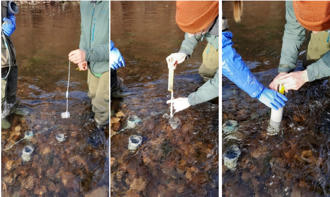
Abbildung 26: Einbringen der Brutbehälter im Sediment über die vorher eingebrachten Platzhalter.
