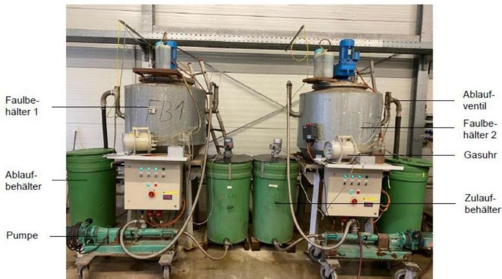
Abbildung 89: Anaerobreaktoren für die Durchführung der halbtechnischen Versuche mit Vorlage- und Auffangbehältern sowie Dosierpumpen und Gasuhren
