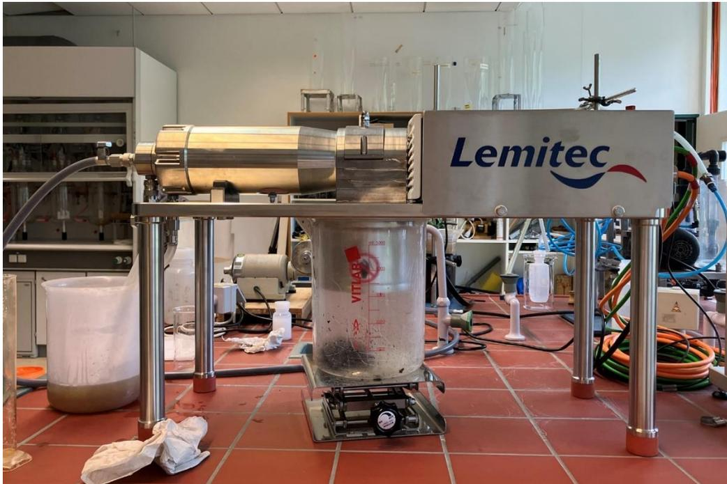
Abbildung 92: Labordekantierzentrifuge MD 60 der Firma Lemitec
