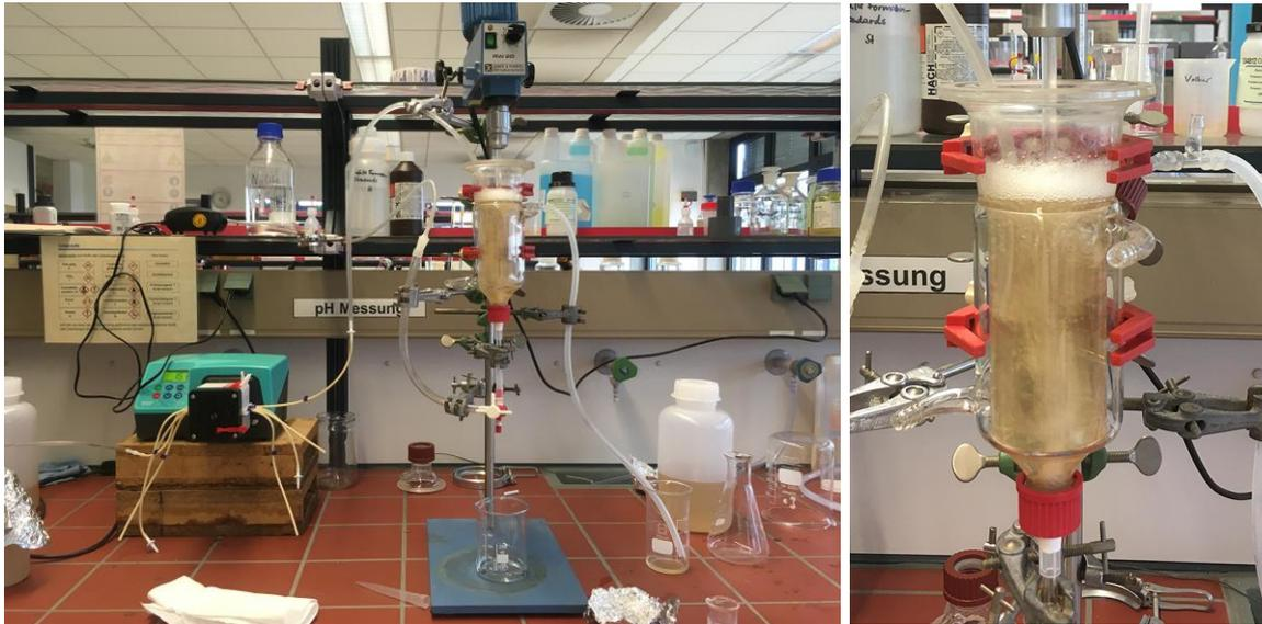
Abbildung 18: Gerührter (Durchfluss-)Reaktor mit Belüftung im Reaktorboden;
