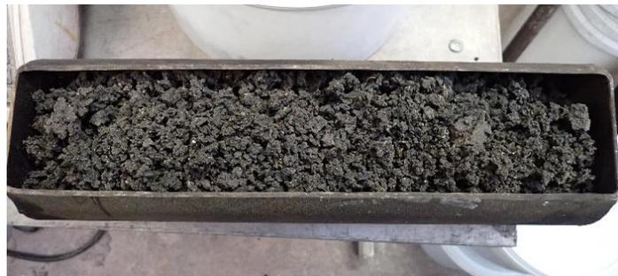
Abbildung 129: eFS in der Schaufel zur Befüllung
