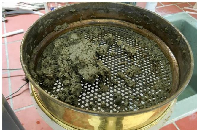
Abbildung 59: Abtrennung grober Faserstoffe nach dem Mazerieren über ein Sieb mit einer Maschenweite von  $d = 4 \text{ mm}$
