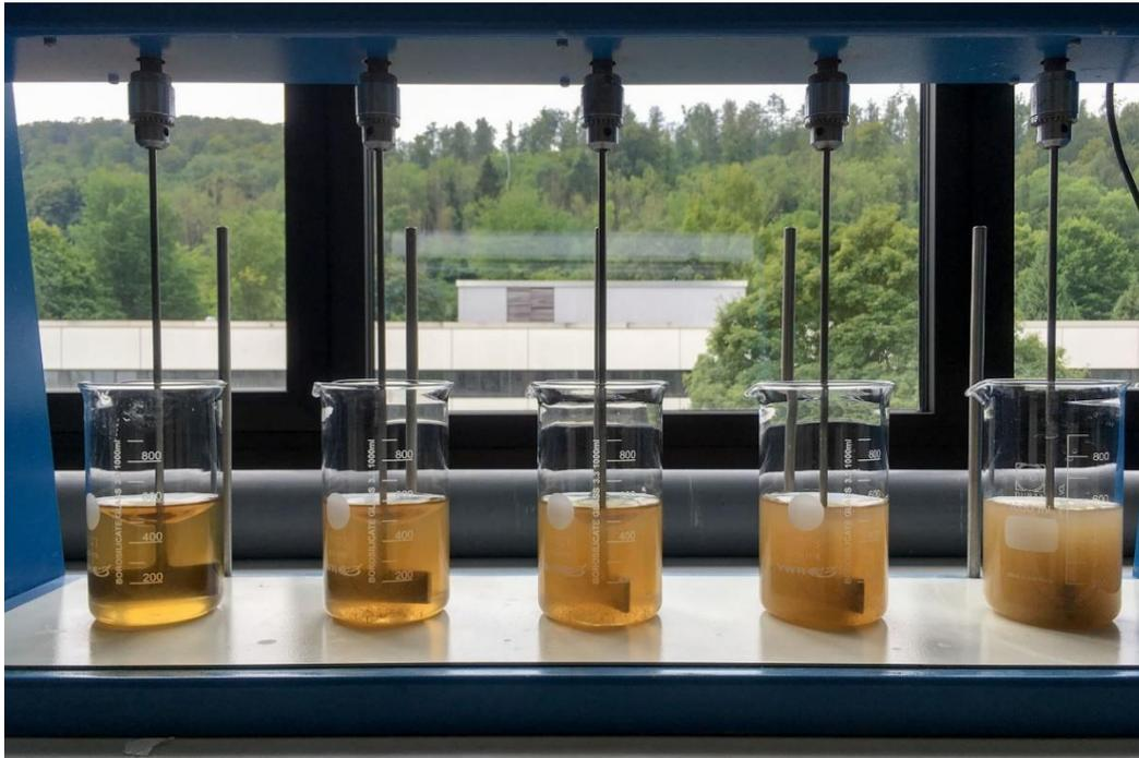
Abbildung 15: Reihenrührbank für die Durchführung der Versuche zur Fällung von Phosphatphosphor
