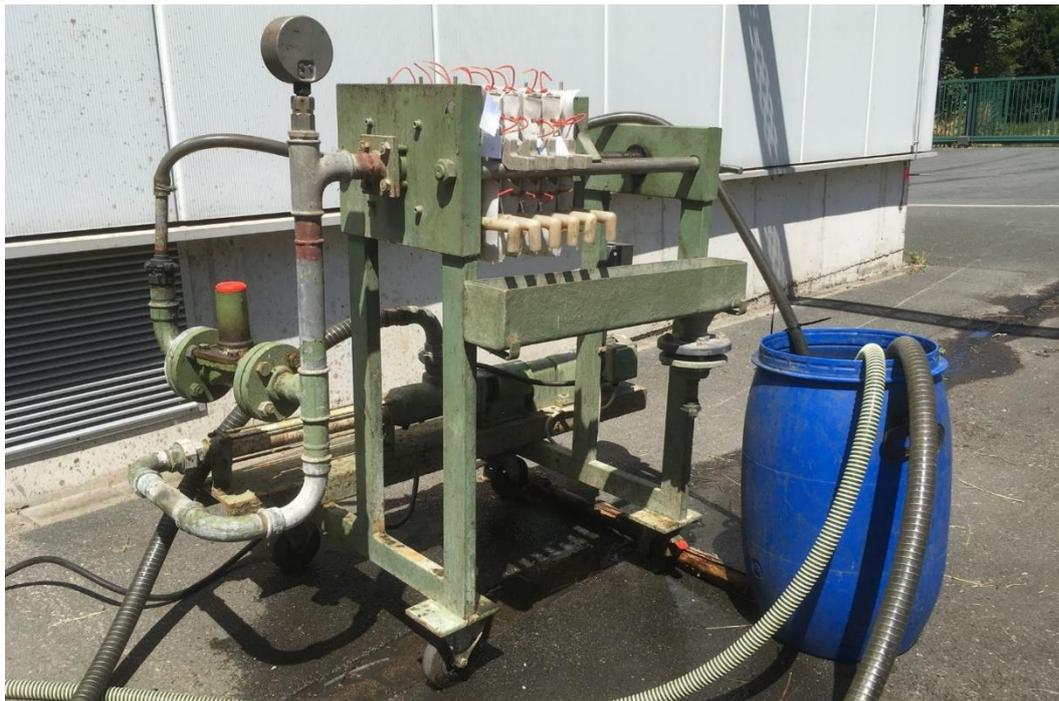
Abbildung 91: Kammerfilterpresse für die Entwässerungsversuche vor Ort
