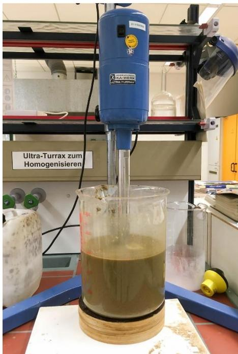
Abbildung 58: Mazerieren des Gemisches aus Überschussschlamm und Primärschlamm
