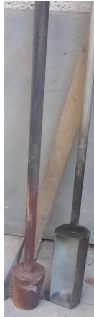
Abbildung 130: Schaufel zur Entleerung (links) sowie zur Befüllung (rechts) des Reaktionsraums
