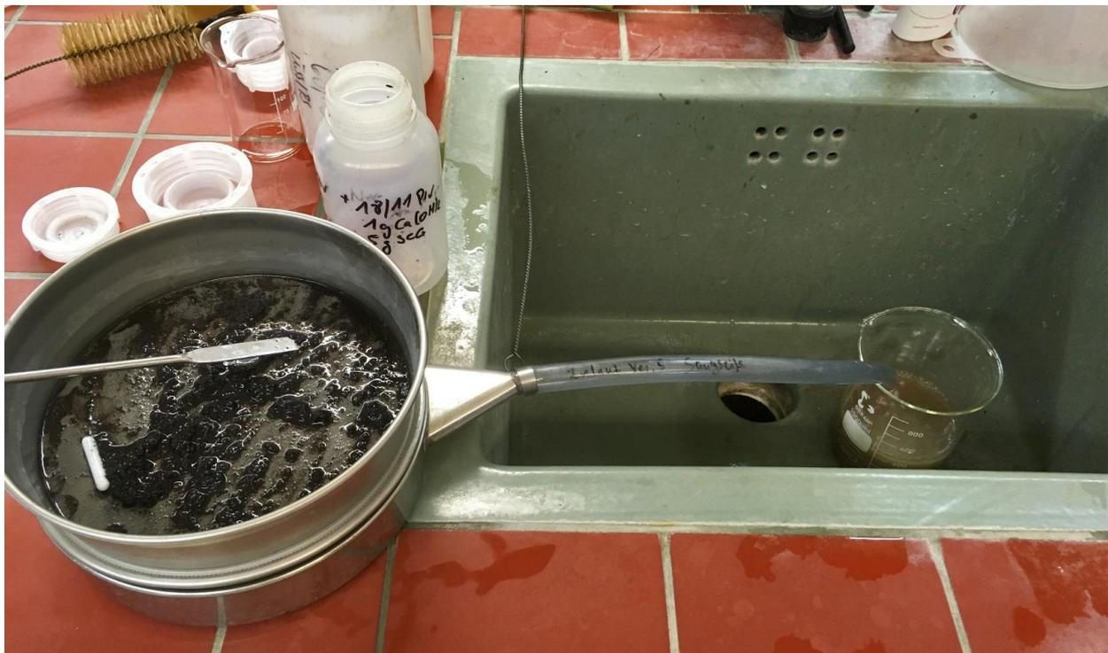
Abbildung 60: Abtrennung des calciumbeladenen SCG aus einem Beladungsansatz über ein Sieb (Maschenweite  $d = 63 \text{ }\mu\text{m}$ ) aus einem kleinen Beladungsansatz
