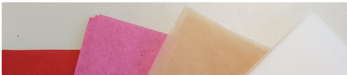
Abbildung 3-1: Auswahl an Garn-Basispapieren für die Charakterisierung. V.l.n.r.: Dekopapier, rot; Dekopapier, erika; Kabelspinnpapier 16 g/qm, braun; Kabelspinnpapier 14,5 g/qm, weiß
