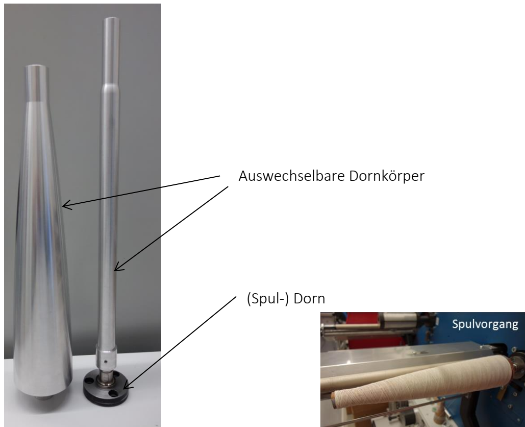
Abbildung 3-3: Angefertigte Dornkörper am Beispiel der Demonstratorleuchte „FIVE STEMS“, mit Spulvorgang
