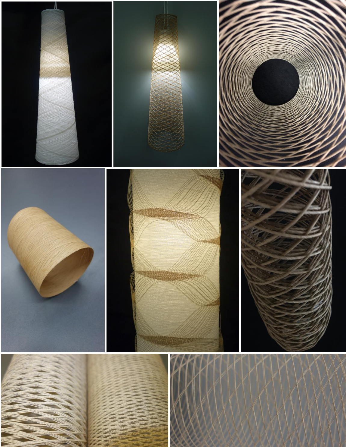
Abbildung 3-18: Beispiele für Funktionsmuster: Lampenschirme mit Diffusoren sowie verschiedene Papiergarnstrukturen
