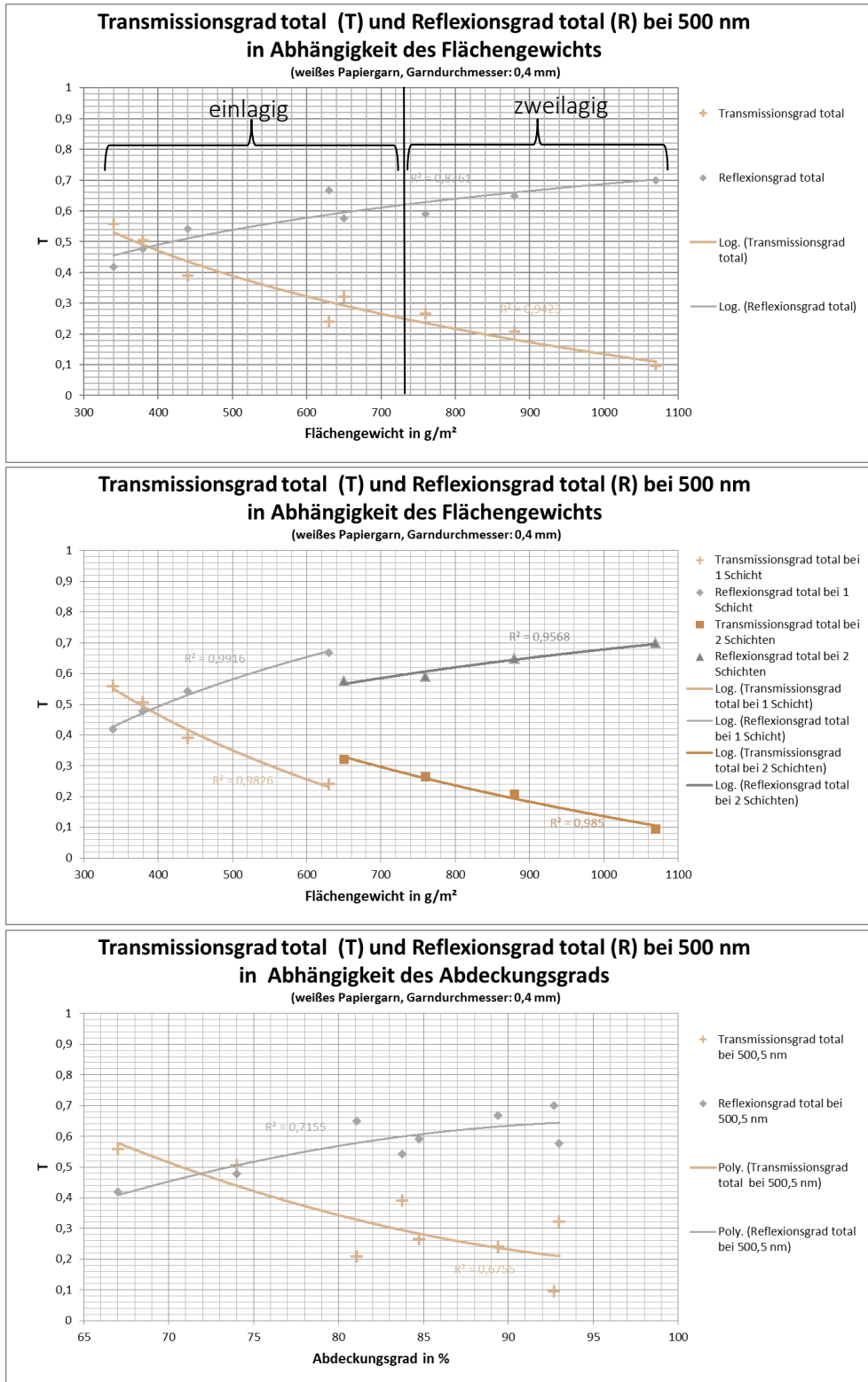
Abbildung 3-28: Transmissions- und Reflexionsgrade in Abhängigkeit vom Flächengewicht bzw. Abdeckungsgrad
