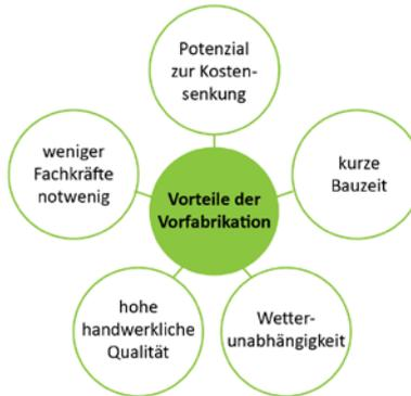
Abbildung 1: Fünf Vorteile der Vorfabrikation
