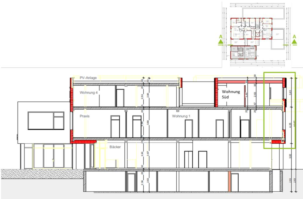
Bei dem Bestandsbau handelt es sich um einen Stahl-Skelettbau, der aus tragenden Stützen, Unterzügen und Deckenscheiben besteht. Die zwei Treppenhäuser sind massiv ausgebaut und dienen zur Aussteifung des Gebäudes.
