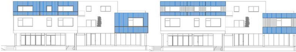
Ein alternativer Vorschlag von ifeu sieht vor, die PV/Solarthermie-Flächen mit der Holzfasade zu umrahmen. Die Fenster bilden mit der PV/Solarthermie eine Einheit und werden gestalterisch durch den Rahmen betont (Abbildung 21).
