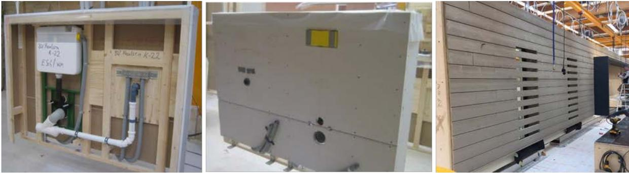
Für den Transport werden die Flächenelemente ineinander gestellt und so platzsparend auf einen LKW verstaut. Ein Vorteil der Vorfertigung von Flächenelementen gegenüber Raummodulen ist, dass durch die platzsparende Transportmöglichkeit weniger „Luft“ transportiert wird.
