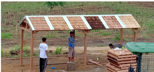
Abbildung 47: Schindeltest Aufbau (Quelle: Fairventures)
