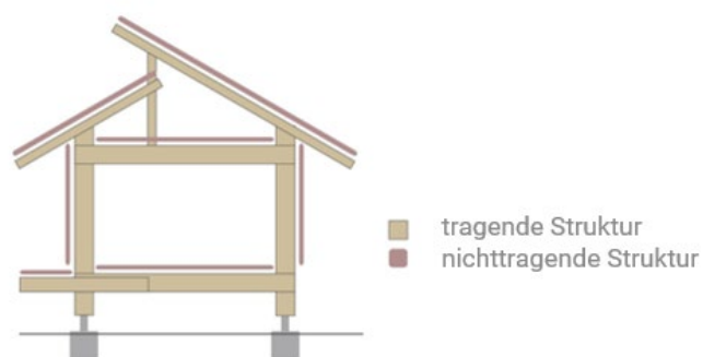
Abbildung 14: schematische Abbildung des Systems (Quelle: Löffler_Schmeling)
