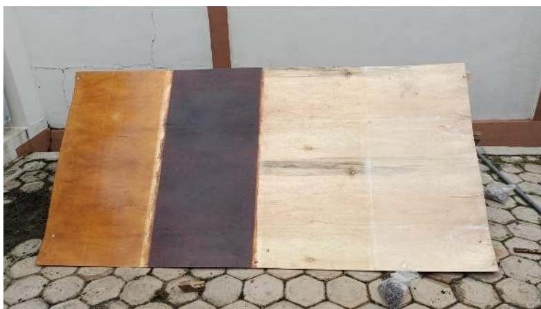
Abbildung 49: Aufbau des Bewitterungstest – Holzschutzmittel (Quelle: Fairventures)
