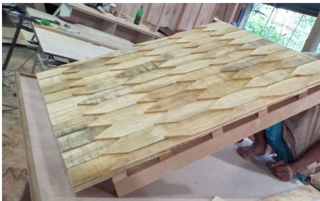
Abbildung 46: Schindeltest Vorbereitung (Quelle: Fairventures)
