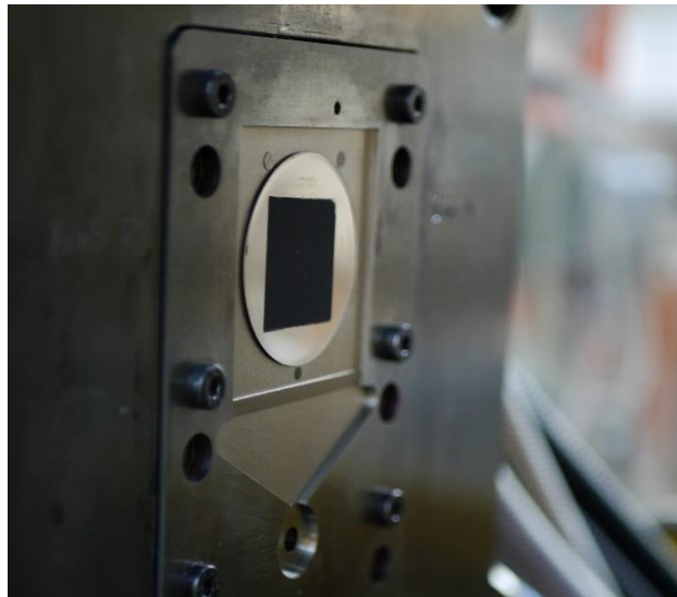
Bild 29: Im Werkzeug fixierte Edelstahlrunde, welche im Vorfeld auf einer standalone Tampondruckanlage bedruckt wurde.
