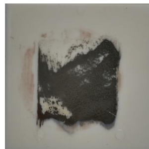
Bild 35: Exemplarische Ergebnisse des Hybridverfahrens unter Nutzung von CI-003 (Cu) auf unverstärktem PBT: (a) unvollständiger Stoffübertrag auf das Substrat, (b) thermische Schädigung und Verschiebung des Druckstoffes.
