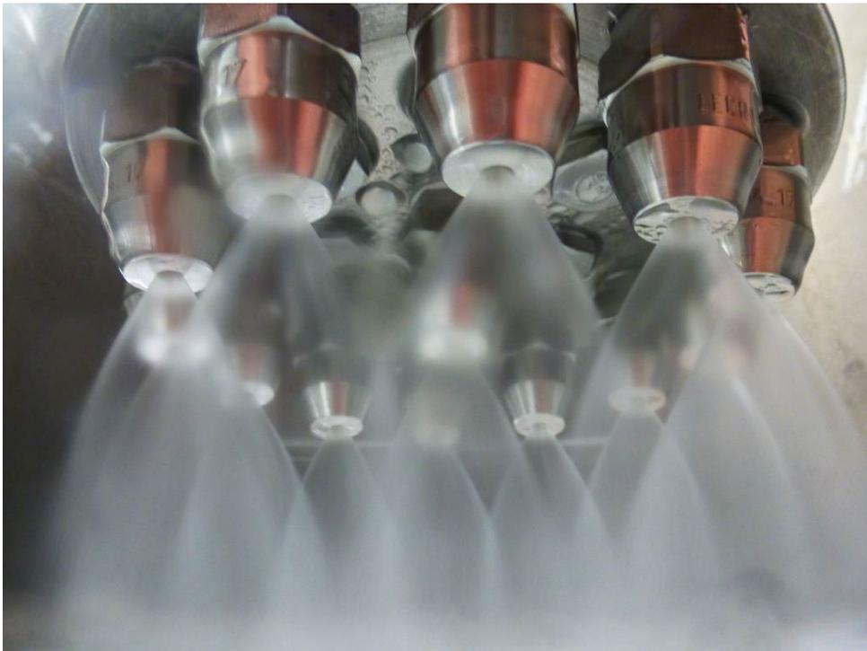
Bild 3-16: Exemplarischer Düsenkopf in einer Waschebene
