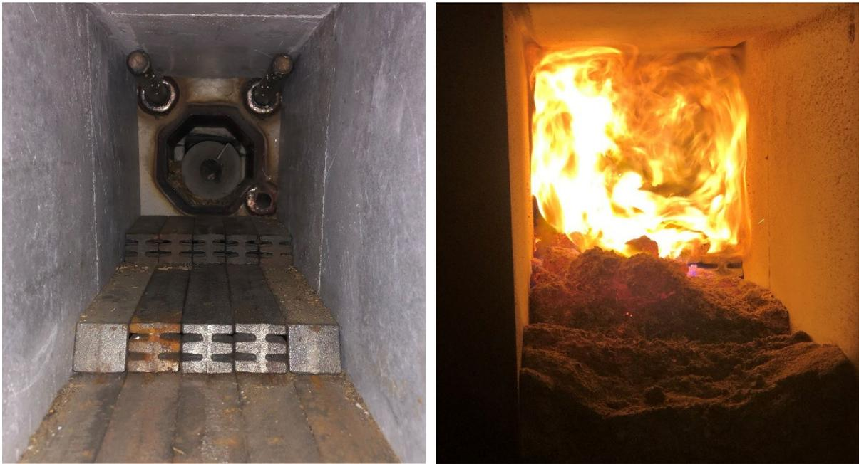
Bild 3-11: Brennkammer der Feuerung (links); Betrieb der Brennkammer (rechts).
