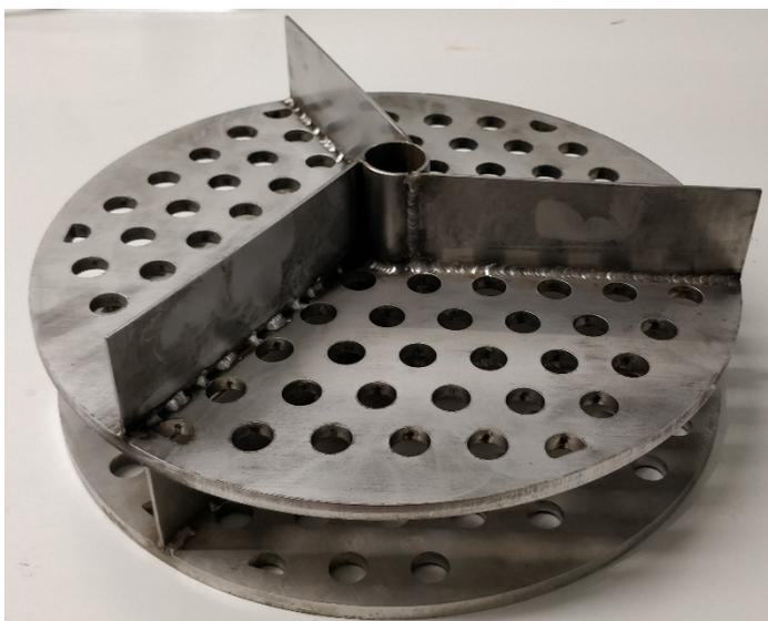
Bild 4-7: Detailaufnahme eines zweistufigen Trays
