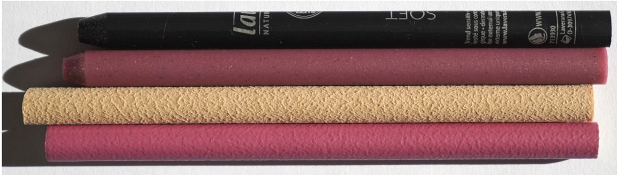
Abbildung 2: von oben nach unten: folierten Cellulose Hülse; undekorierte Cellulose Hülse; undekorierte Sulapac-Hülse (Flow 1.7); folierte Sulapac-Hülse (Flow 1.7)
