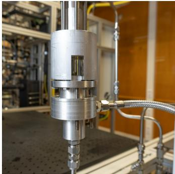
**Abbildung 3.12:** Glasejektor im eingebauten Zustand
