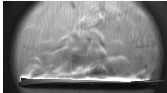
**Abbildung 3.17:** Mit dem Prüfstand angefertigte Schlierenaufnahme einer heißen Platte in vertikaler und horizontaler Ausrichtung[3].
