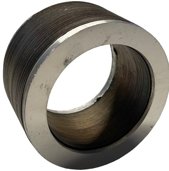
Abbildung 5.14: Abgedrehter Versuchsrotor für die elektromagnetischen Messungen.
