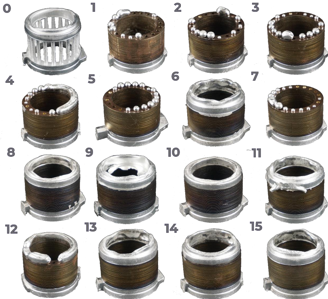
Abbildung 5.13: Bemusterung des Mindestanforderungsprofils an die Gießparameter für den Abguss der Testgeometrie
