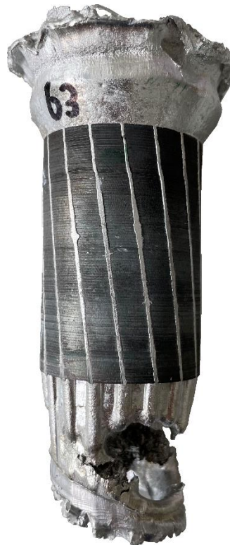
Abbildung 5.17: Abguss der Realgeometrie im Niederdruckgießverfahren
