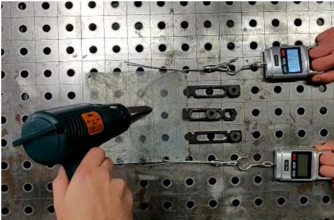
Abbildung 8 Trennung des Prüfkörpers mittels Schneidedraht und gleichzeitiger Erwärmung des Prüfkörpers mittels Heißluftgebläse.
