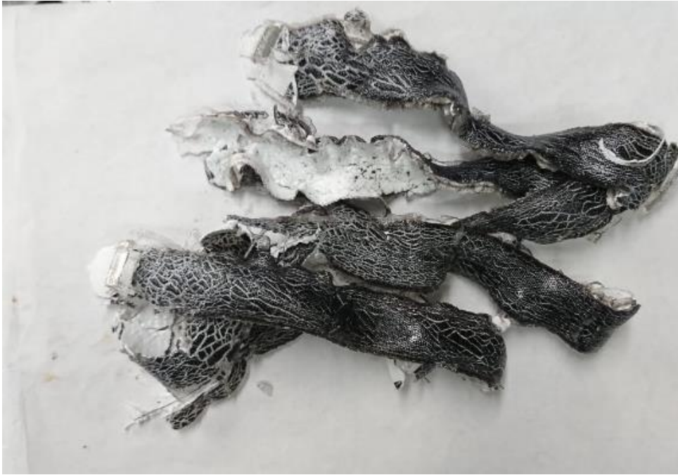
Abbildung 37 EVA-, Si- und Rückseitenfolienrückstände nach dem Experiment.
