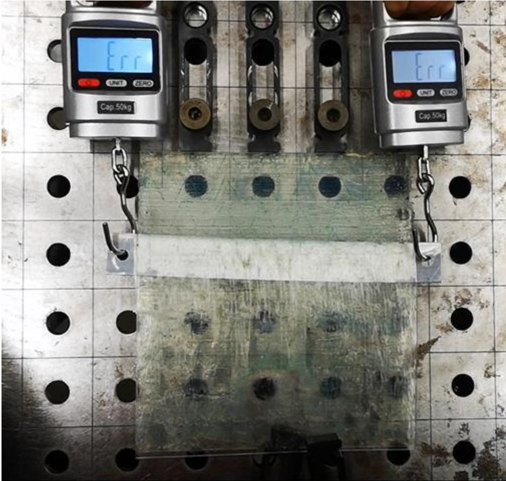
Abbildung 10 Versuchsaufbau für die Klingenabtrennung mit 100 kg Zugkraft.
