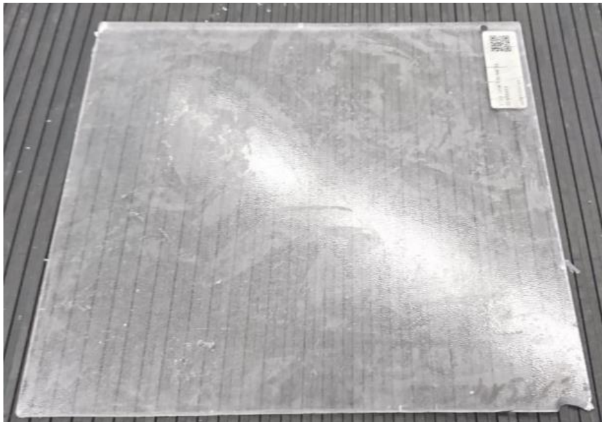
Abbildung 36 Zurückgewonnenes Glas nach dem Versuch
