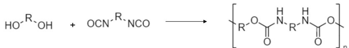
Abbildung 3-18: Bildungsreaktion der Polyurethane aus einem Polyol (hier CO 2 -Polyol) und einem Diisocyanat, dass ein zweikomponentiges System darstellt
