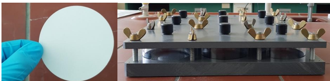
Abbildung 6: Membran-Stanzling (links) Spannvorrichtung für Rüttelversuch (rechts)
