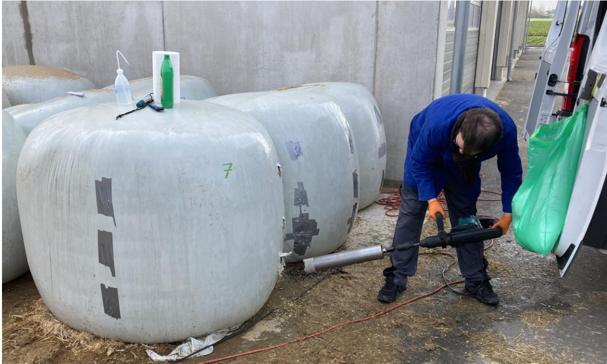
Abbildung 17: Zweite Messung und Probenahme: Probenahme mit dem Kernbohrer an der tiefsten Messstelle (im Bild: B. Zimmermann, Bild: N. Hagemann / Ithaka Institut).
