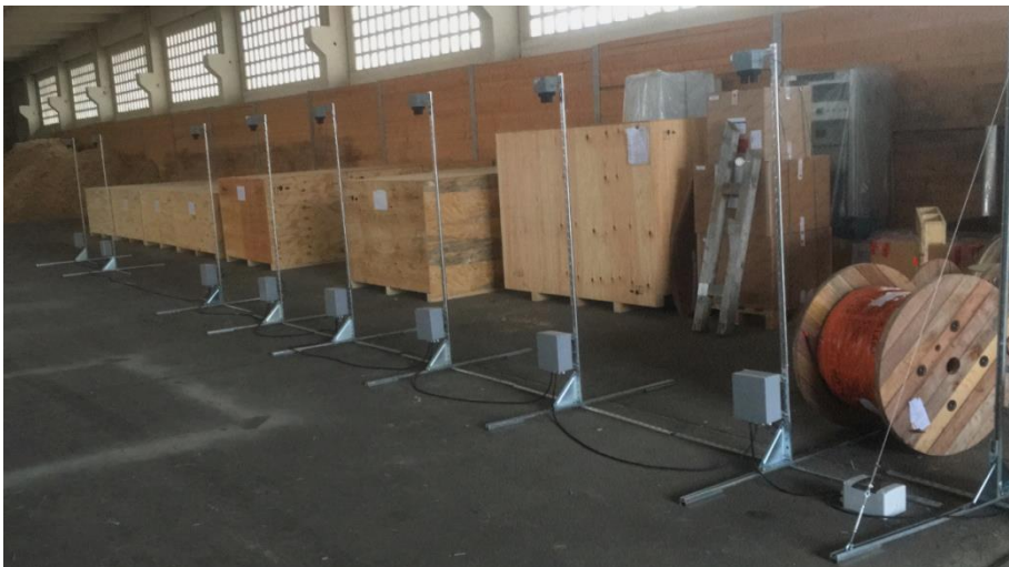
Abbildung 6: Sensoren auf Gestellen montiert für Feldeinsatz
