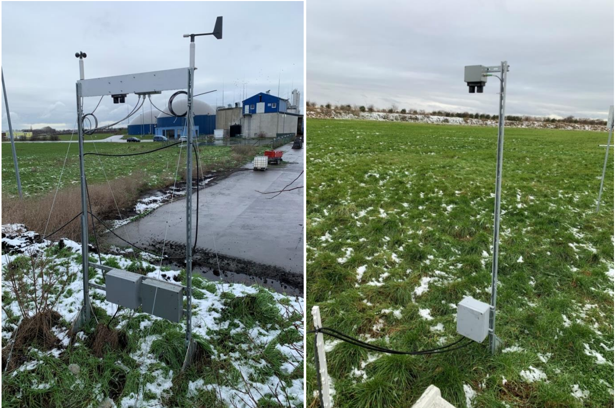
Abbildung 7: Sensor 1 (l. i. B.) mit Windsensoren, ESP-Mastern sowie LTE-Router und Sensor 2 (r. i. B.)
