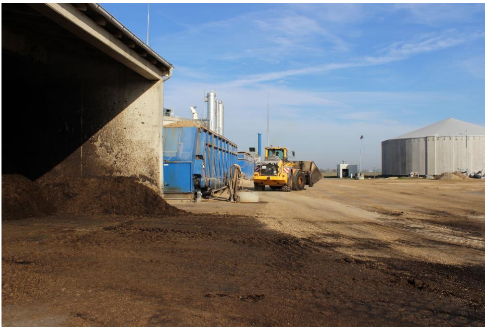
Abbildung 4: Mischung Gärsubstrat (Betonkuh) und im rechts Hintergrund automatische Dosierung der Fermenter – Schrot plus Gärrestsubstrat (im Bedarfsfall Grundwasser)
